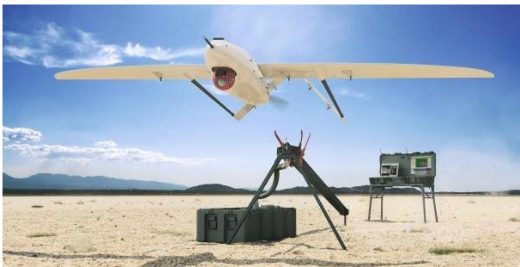
Slika 2.16 Penguin C (UAV Factory), MALE letjelica trajanja leta do 20 h [38]
