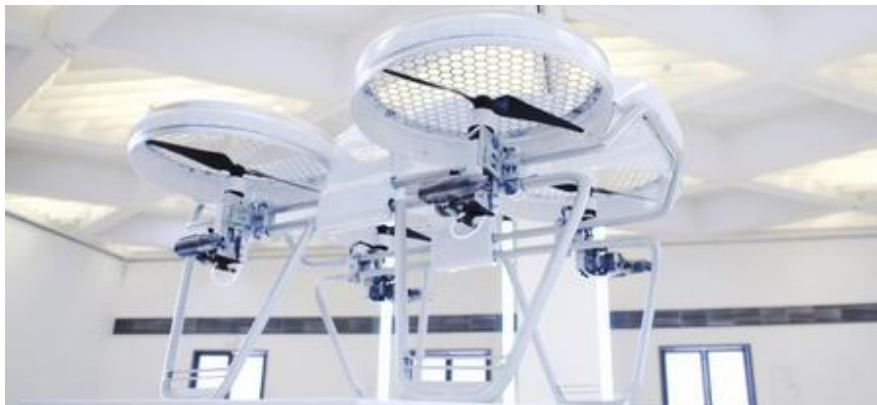
Slika 2.17 Letjelica Yearir s četiri rotora i hibridnim pogonom (prototip) [39]
