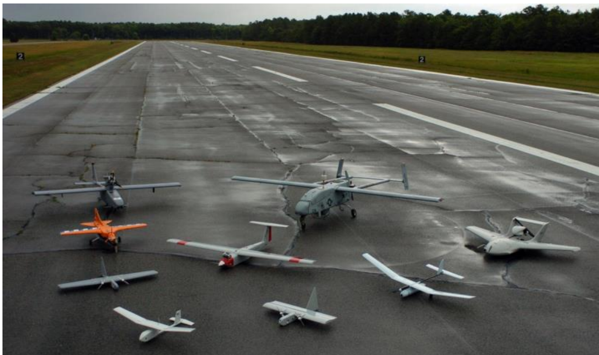
Slika 2.6 LALE/LASE letjelice: prva sprijeda je RQ-11A Raven; slijeva nadesno u drugom redu su Evolution i Dragon Eye; u trećem redu slijeva nadesno su NASA FLIC, Arcturus T-15 i Skylark, a u posljednjem redu su letjelice RQ-2B Pioneer, Tern i Neptune [1]
