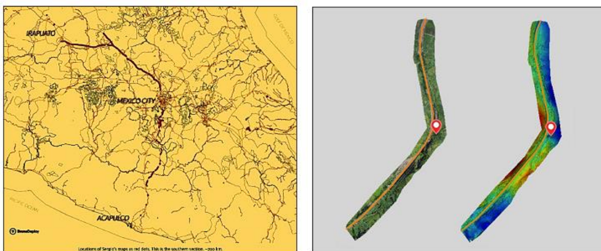
Slika 3.1 Mapirana fotografija ceste (lijevo) i ortomozaik 9 i DSM model (desno) [42]
