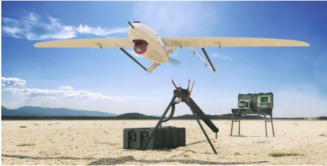
Slika 2.16 Penguin C (UAV Factory), MALE letjelica trajanja leta do 20 h [38]
