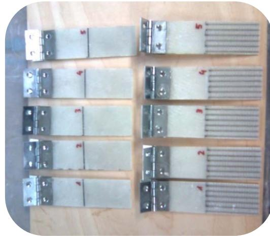
Slika 41 Ljepljenje zglobnog prihvata u čeljusti kidalice
