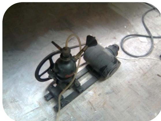
Slika 38 Vakuum pumpa – 150 mbar (85% vakuum)
