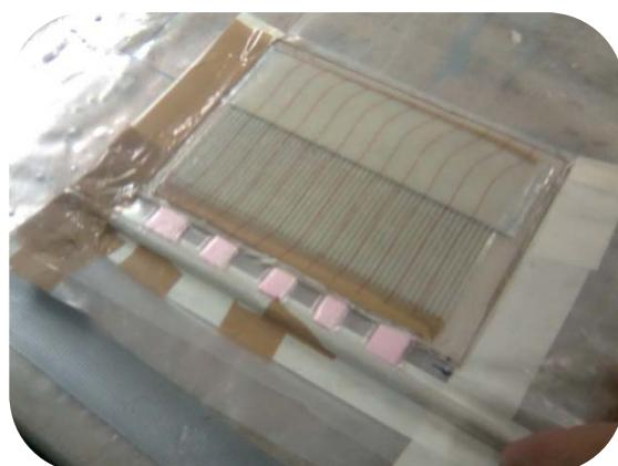
Slika 37 Zatvaranje laminata sa prethodnog šivanim slojevima i vakuumiranje
