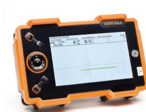
Slika 13: Uredaj za ultrazvučno mjerjenje debljine USM GO+
