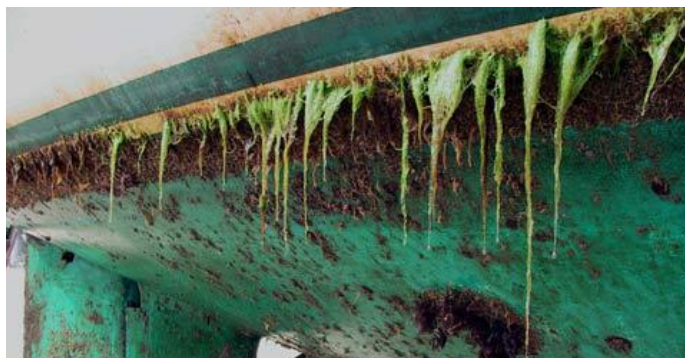
Slika 9. Obraštaj algama i balanidima [16]
