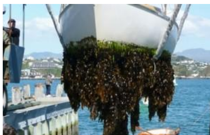
Slika 11. Slučaj teškog mekog i tvrdog makroobraštaja [18]
