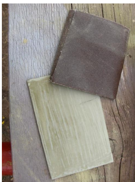
Slika 30. Aktiviranje antikorozivnog Premaza P1 brušenjem
