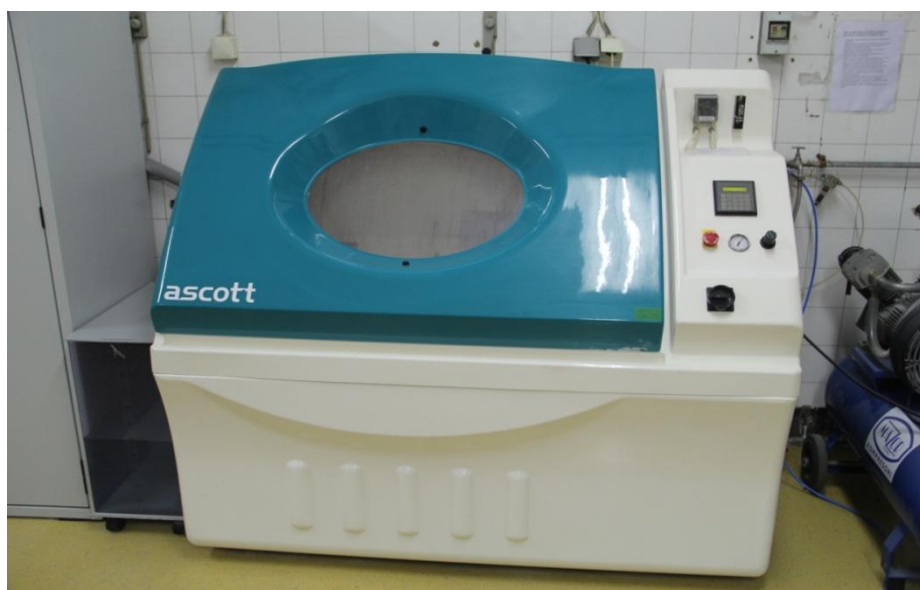
Slika 62. Slana komora, Laboratorij za zaštitu materijala, FSB
