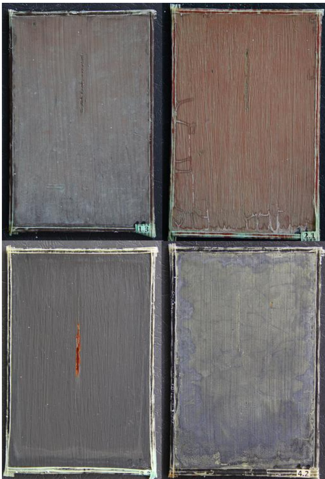
Slika 64. Uzorci nakon 480 sati provedenih u slanoj komori
