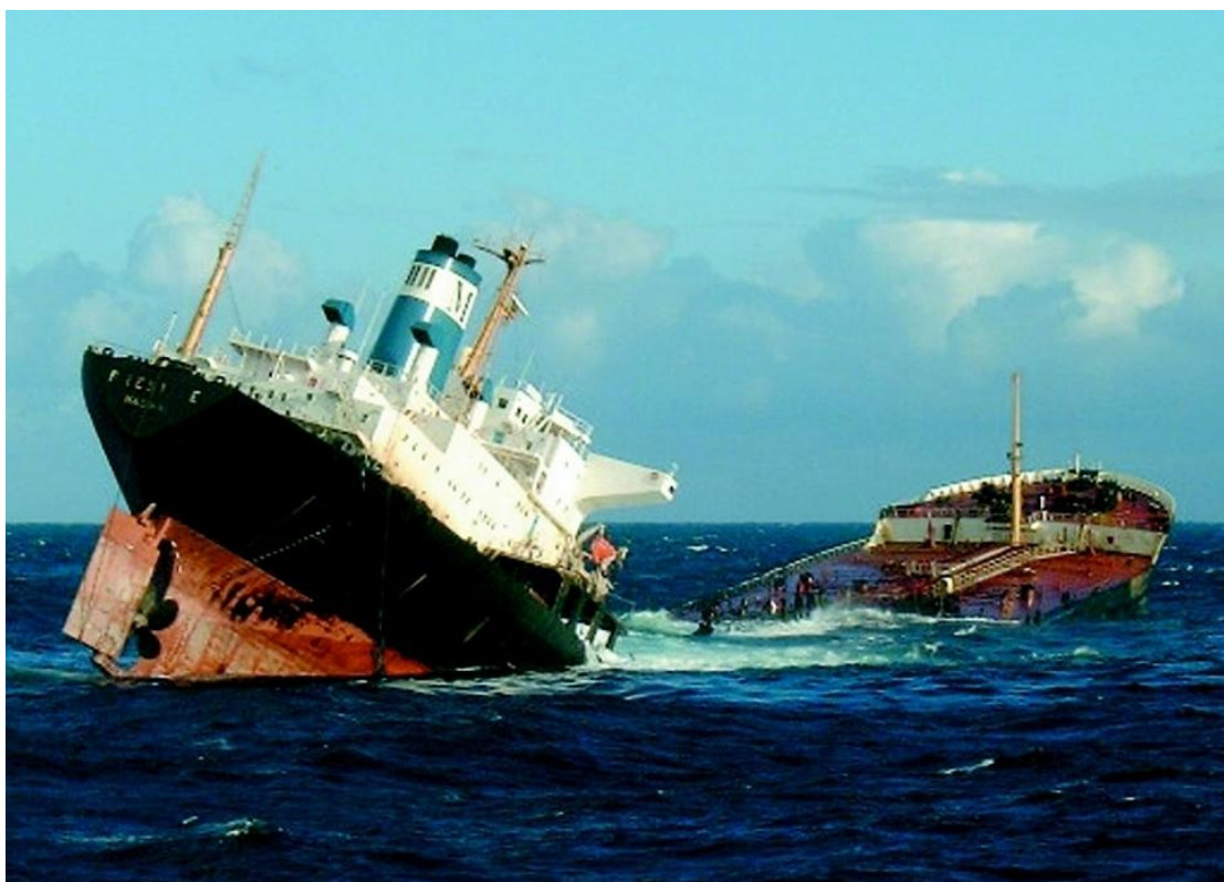
Slika 2. Tanker „Erika“ - kolaps brodske konstrukcije uslijed djelovanja korozije [7]
