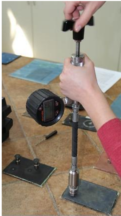
Slika 66. Postupak mjerenja adhezije premaza uređajem Elcometer 108
