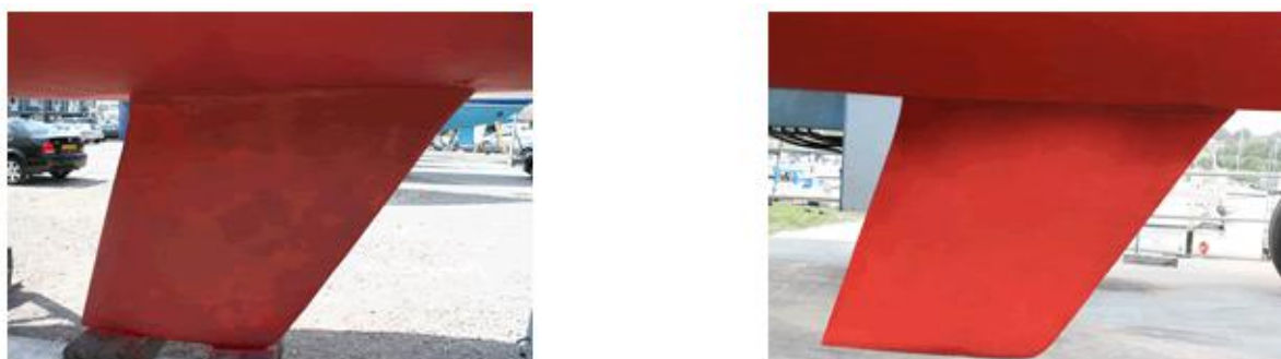
Slika 34. Prikaz Premaza AV 3 prije i nakon uranjanja [33]
