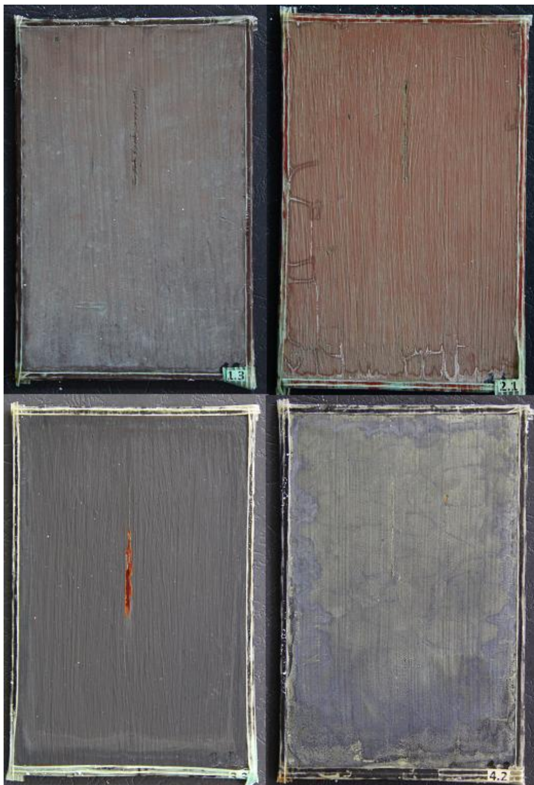
Slika 64. Uzorci nakon 480 sati provedenih u slanoj komori
