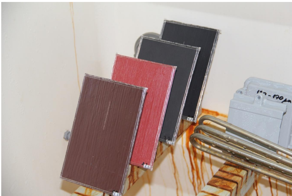
Slika 63. Uzorci u slanoj komori
