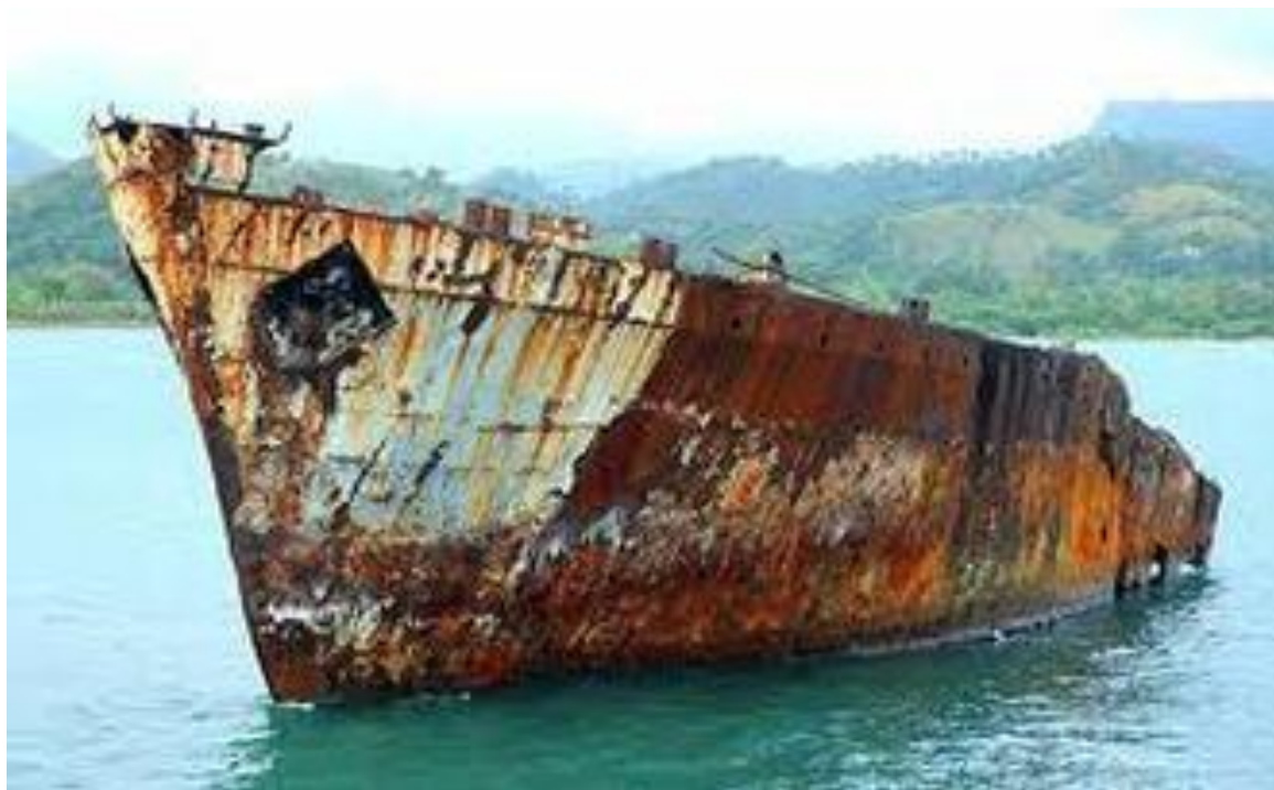
Slika 1. Brod oštećen korozijom [4]
