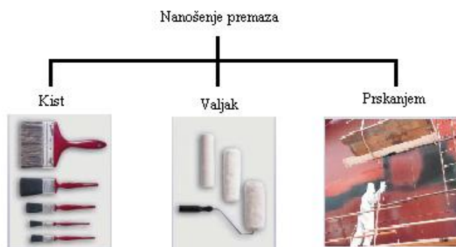
Slika 16. Načini nanošenja premaza
