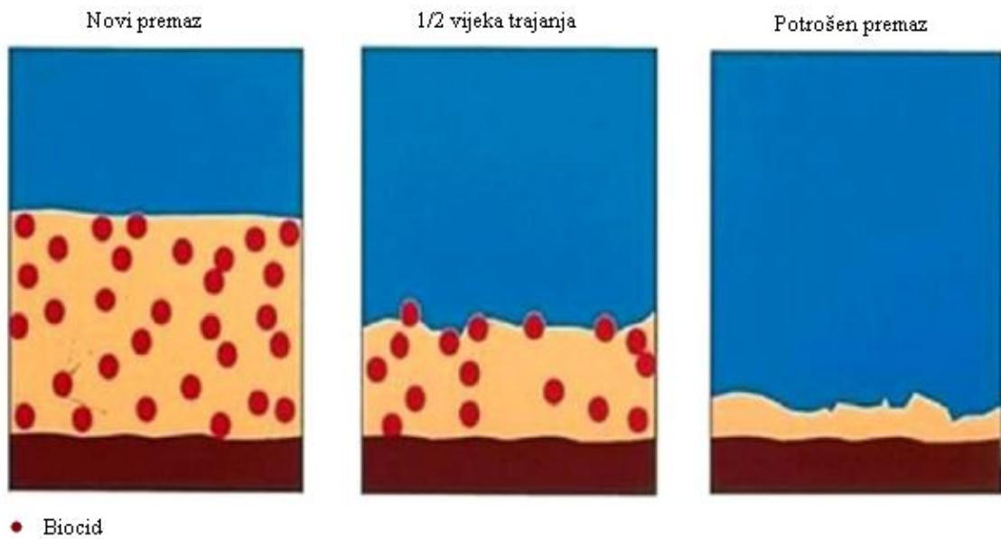
Slika 13. Shema trošenja premaza s topivom matricom [26]
