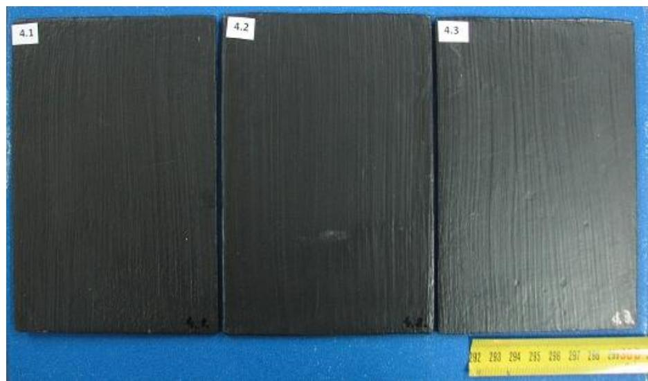
**Slika 37. Ispitni uzorci zaštićeni Premzom AV 4**
