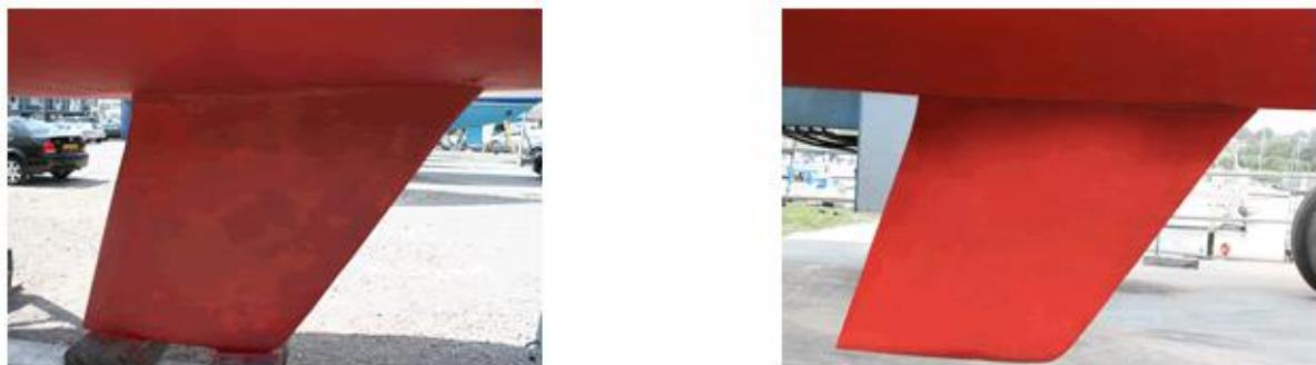
**Slika 34. Prikaz Premaza AV 3 prije i nakon uranjanja [33]**
