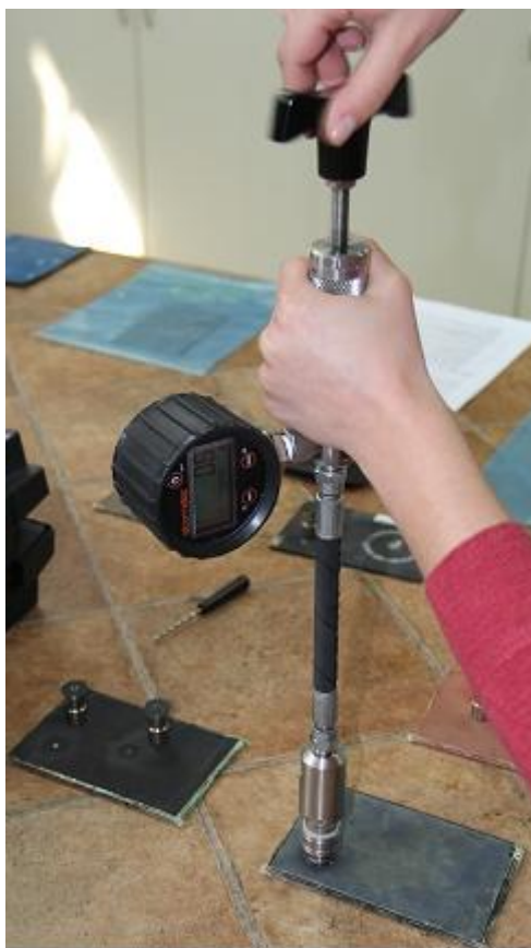
Slika 66. Postupak mjerenja adhezije premaza uređajem Elcometer 108
