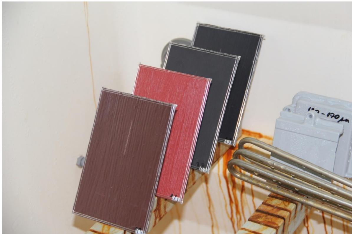
**Slika 63. Uzorci u slanoj komori**
