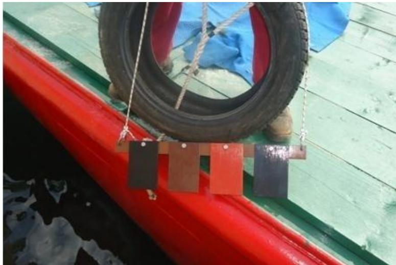
**Slika 38. Uranjanje uzorka**
