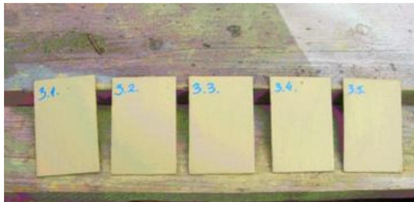
**Slika 31. Označeni uzorci nakon zaštite antikorozivnim Premazom P1**
