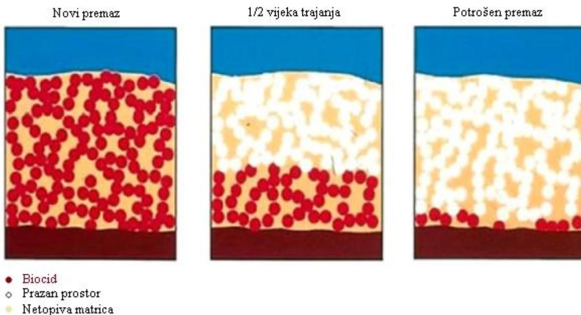
Slika 14. Shema trošenja premaza s netopivom matricom [26]
