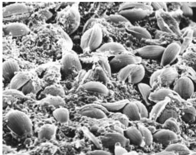
**Slika 4. Skeniranje elektronskim mikroskopom sluzi dijatomeja koje rastu na protuobraštajućem premazu baziranom na bakru [12]**
