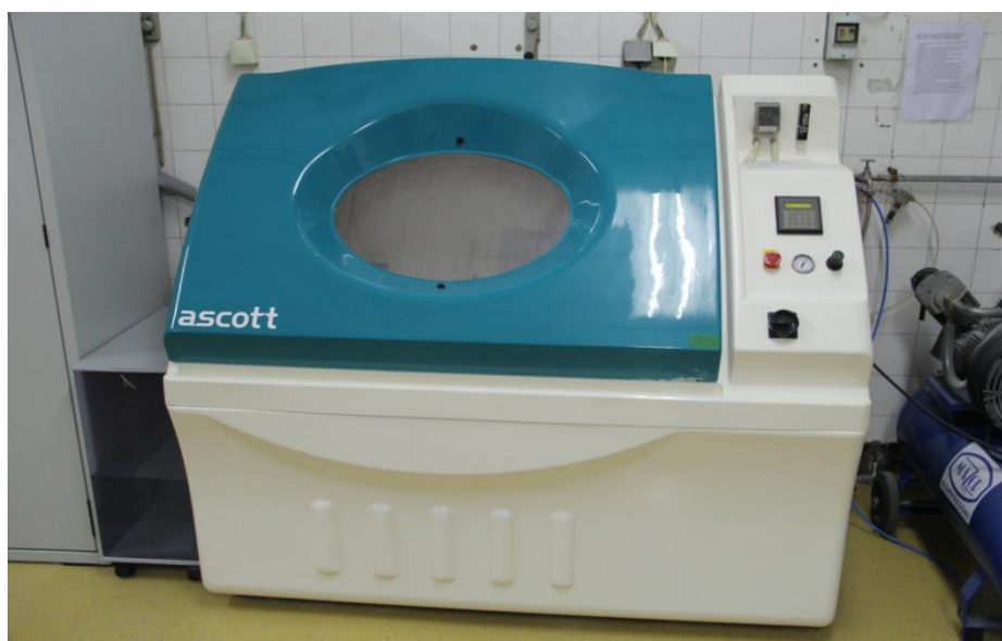
Slika 62. Slana komora, Laboratorij za zaštitu materijala, FSB
