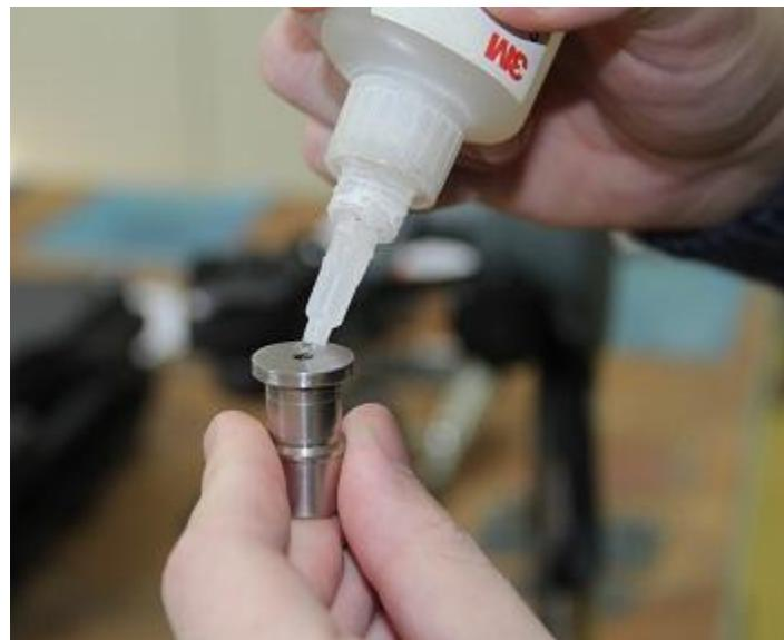
Slika 65. Nanošenje ljepila na ispitni valjak
