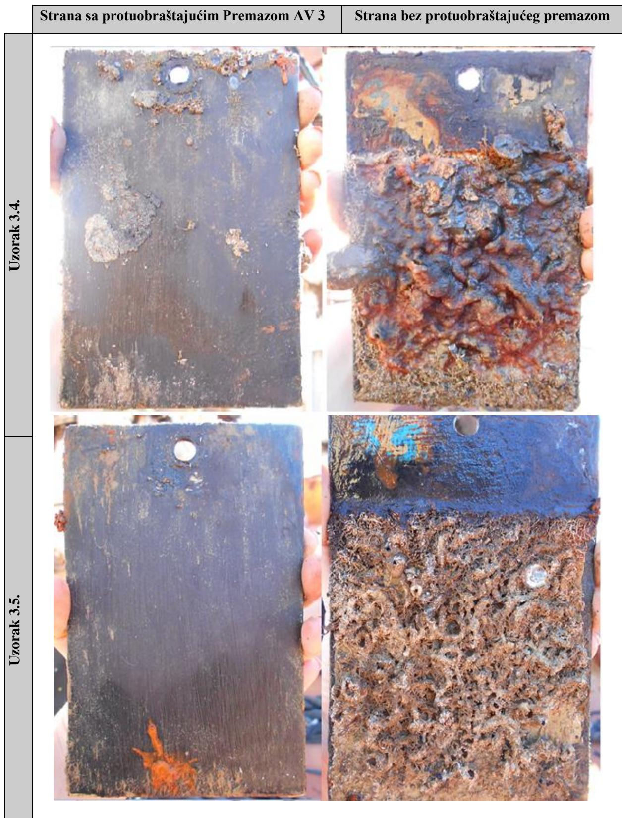
**Slika 45. Uzorci 3.4. (izložen suncu) i 3.5. (u hladu) zaštićeni Premazom AV 3, godinu dana nakon uranjanja u more**
