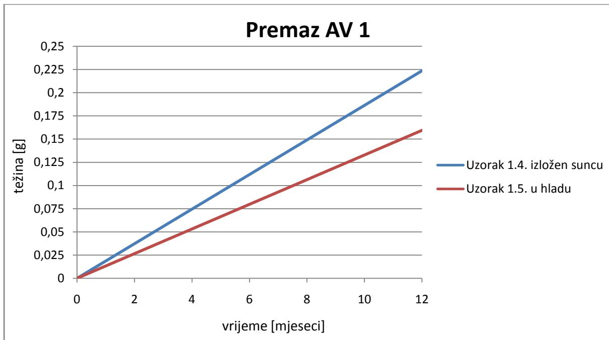
**Slika 53. Prikaz porasta obraštaja na uzorcima uronjenim u more na godinu dana 1.4. i 1.5. zaštićenih Premazom AV 1**
