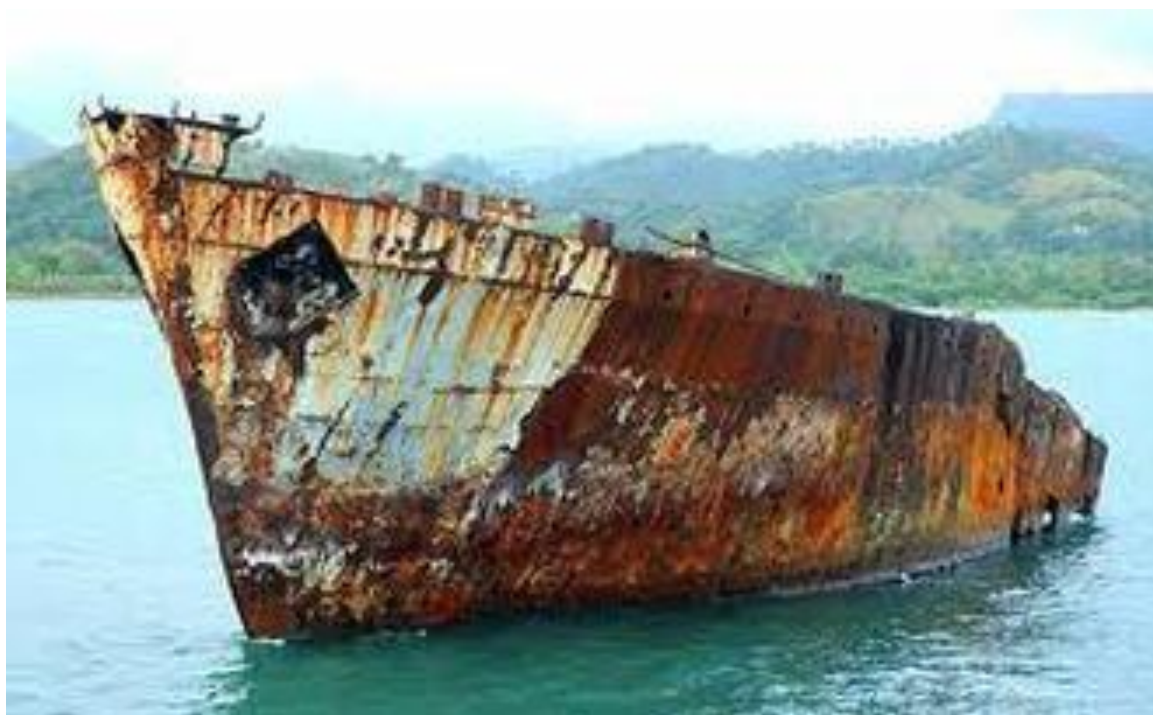
Slika 1. Brod oštećen korozijom [4]
