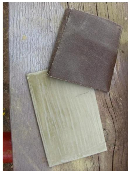
**Slika 30. Aktiviranje antikorozivnog Premaza P1 brušenjem**
