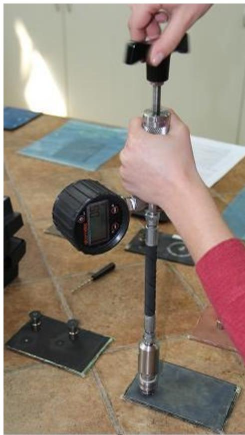
**Slika 66. Postupak mjerena adhezije premaza uređajem Elcometer 108**
