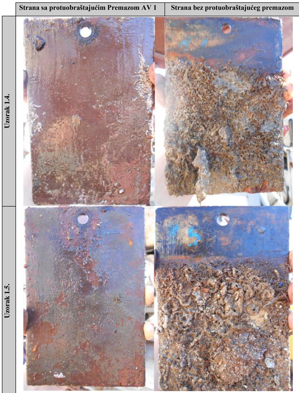
**Slika 43. Uzorci 1.4. (izložen suncu) i 1.5. (u hladu) zaštićeni Premazom AV 1, godinu dana nakon uranjanja u more**
