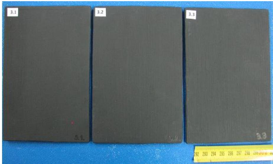
**Slika 36. Ispitni uzorci zaštićeni Premazom AV 3**
