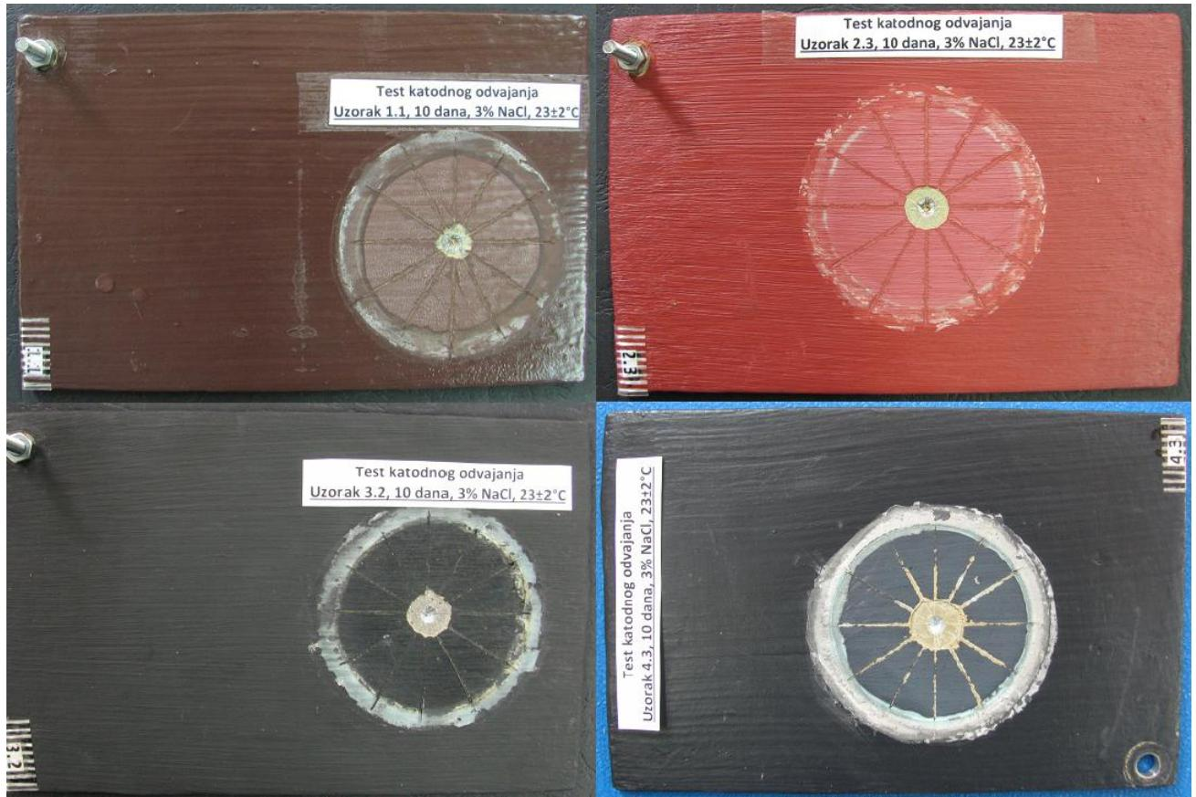
**Slika 61. Zarezani djelovi kružnog presjeka pod kutem  $30^\circ$  i odvojeni centralni dio od podloge**
