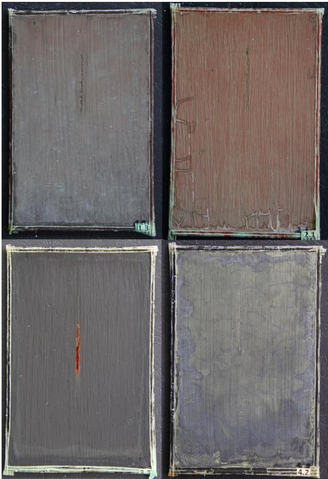
**Slika 64. Uzorci nakon 480 sati provedenih u slanoj komori**
