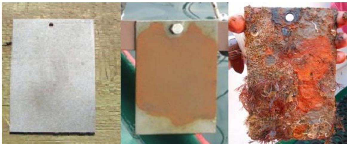
Slika 26. Čelični uzorak (pločica) prije uranjanja, nakon tjedan dana provedenih u moru, vidljiva je opća korozija i nakon 8 mjeseci provedenih u moru, vidljivi su korozni produkti i obraštaj
