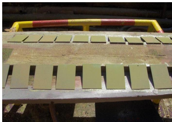
**Slika 29. Čelični uzorci zaštićeni antikorozivnim Premazom P1**
