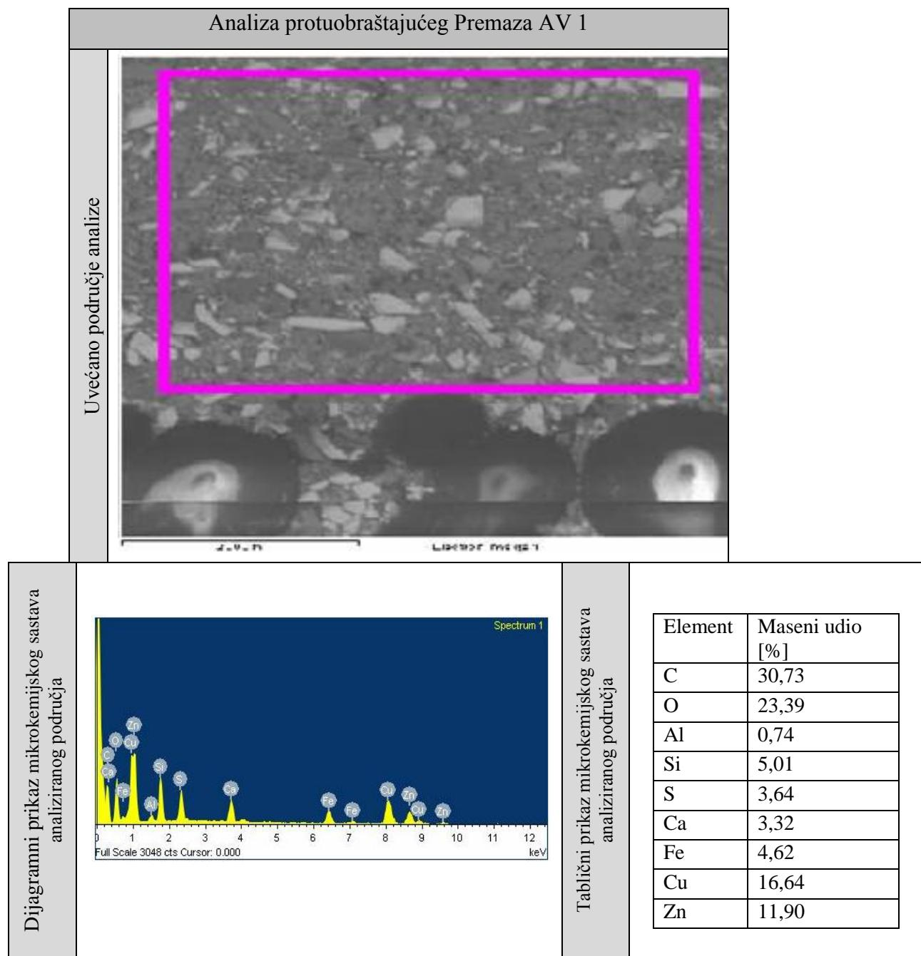
Slika 72. Analize protuobraštajućeg premaza AV 1
