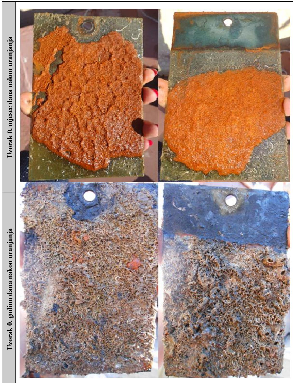
Slika 47. Nezaštićeni uzorak 0. mjesec i godinu dana nakon uranjanja
