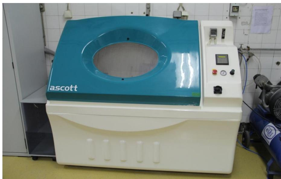
**Slika 62. Slana komora, Laboratorij za zaštitu materijala, FSB**
