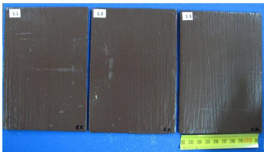
**Slika 32. Ispitni uzorci zaštićeni Premazom AV 1**
