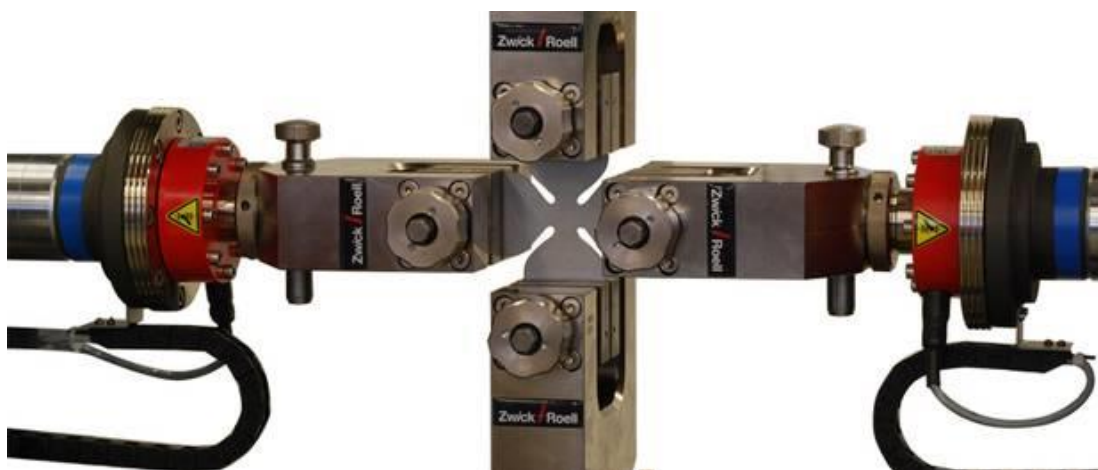
Slika 2.1. Zwick-Roell dvoosni prihvat za križni ispitni uzorak [1]
