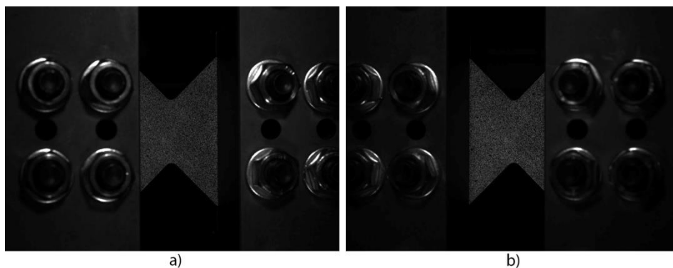
Slika 6.7. Slika postavljenog ispitnog uzorka za ispitivanje smičnog opterećenja sa: a) lijeve kamere, b) desne kamere
