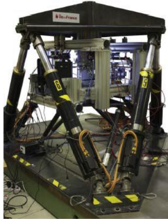
Slika 2.3. 6-osni stroj s odgovarajućim digitalnim kamerama [3]
