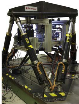
Slika 2.3. 6-osni stroj s odgovarajućim digitalnim kamerama [3]
