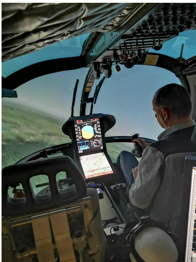
Slika 7 Provođenje eksperimenta sa “pilotom u petlji” za zadatak praćenja zadanog kuta valjanja
