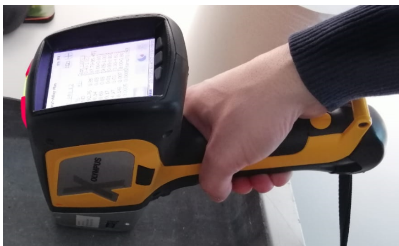
Slika 37: Ispitivanje kemijskog sastava uzoraka XRF metodom
