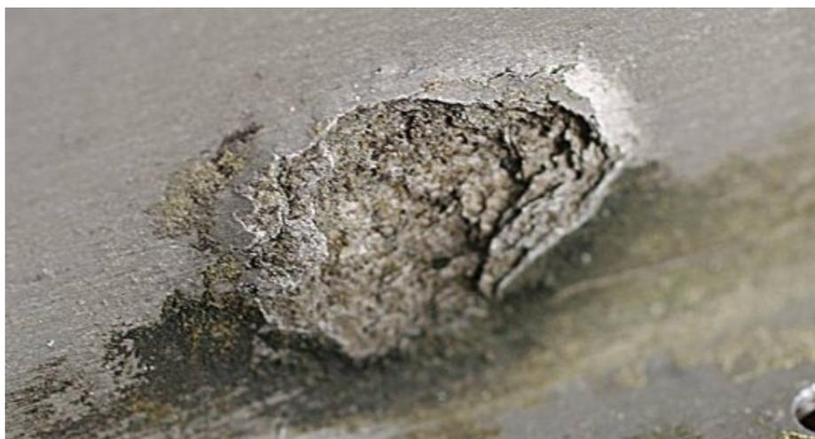
**Slika 21:** Raspljavanje aluminijske legure uslijed interkristalne korozije [37]
