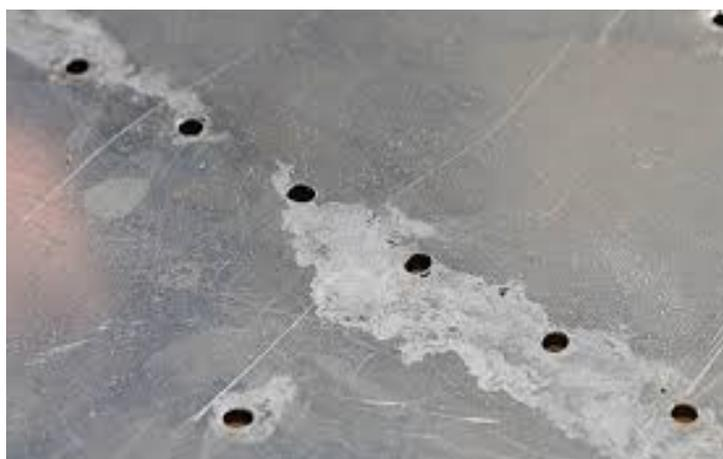
**Slika 13:** Korozija na mjestu spojeva zakovicama na oplati zrakoplova [25]
