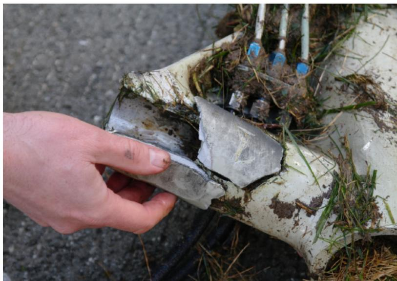
**Slika 3:** Puknuće noge glavnog podvozja zrakoplova Jetstream 31 [7]
