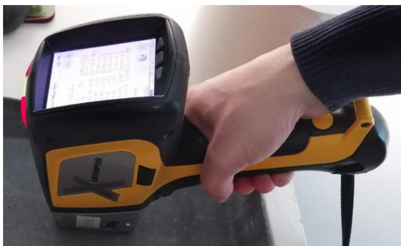
**Slika 37:** Ispitivanje kemijskog sastava uzoraka XRF metodom
