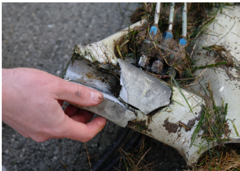
Slika 3: Puknuće noge glavnog podvozja zrakoplova Jetstream 31 [7]
