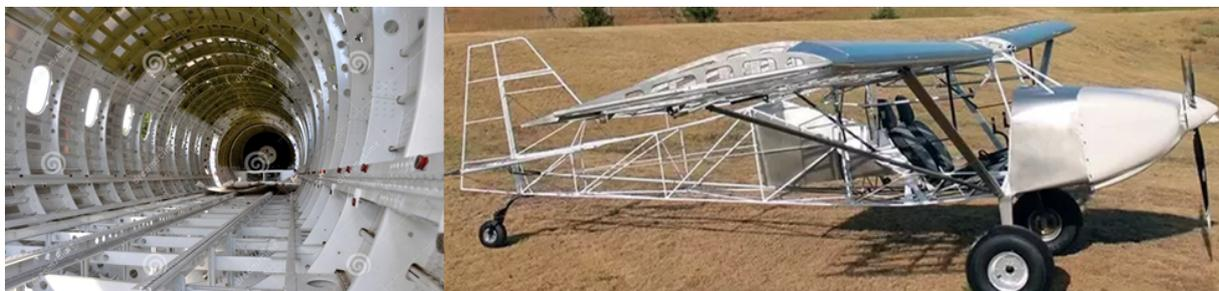
**Slika 2:** Primjena aluminijevih legura u zrakoplovstvu[5, 6]: a) okviri i uzdužnice putničkog zrakoplova, b) rešetkasta konstrukcija zrakoplova generalne avijacije
