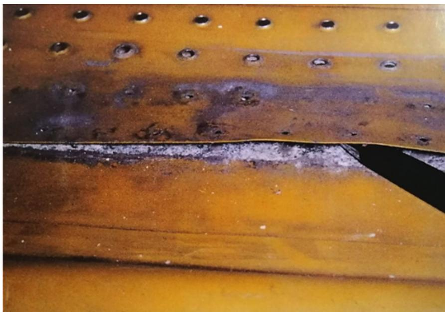
**Slika 20:** Oštećena oplata zrakoplova uslijed korozije u procjepu [35]
