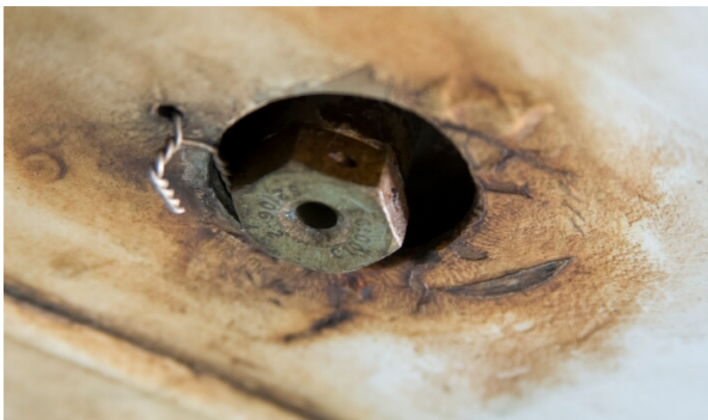
Slika 14: Korodirani aluminijski dio na zrakoplovu [27]
