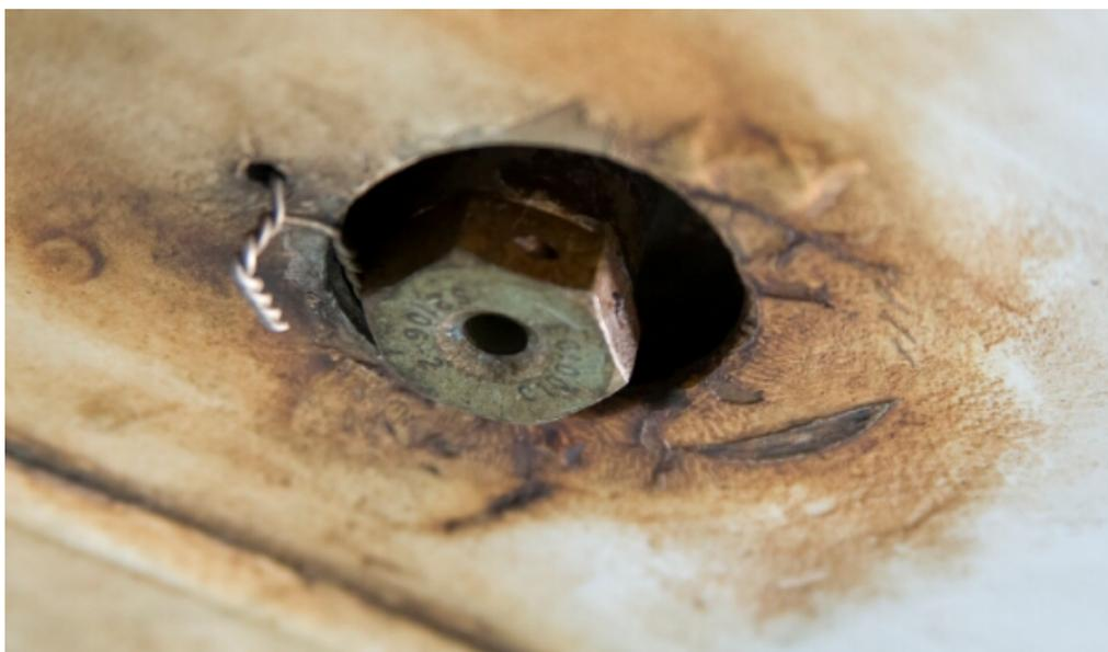
**Slika 14:** Korodirani aluminijski dio na zrakoplovu [27]
