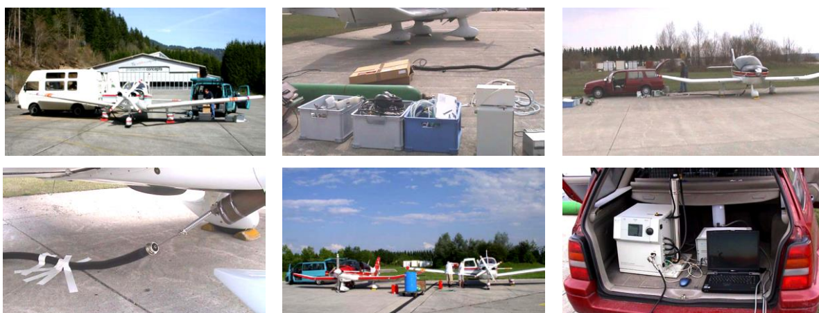
Slika 13. Primjer statičkog mjerenja emisija na tlu [28]
