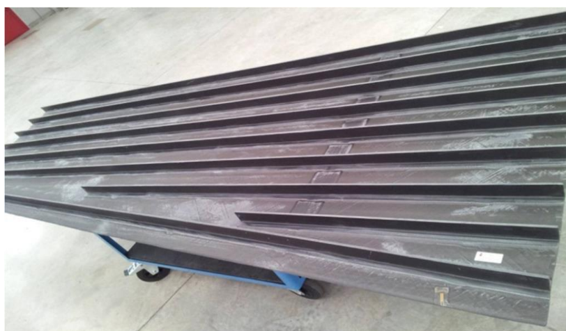
Slika 2. Kompozitni panel krila zrakoplova [1]
