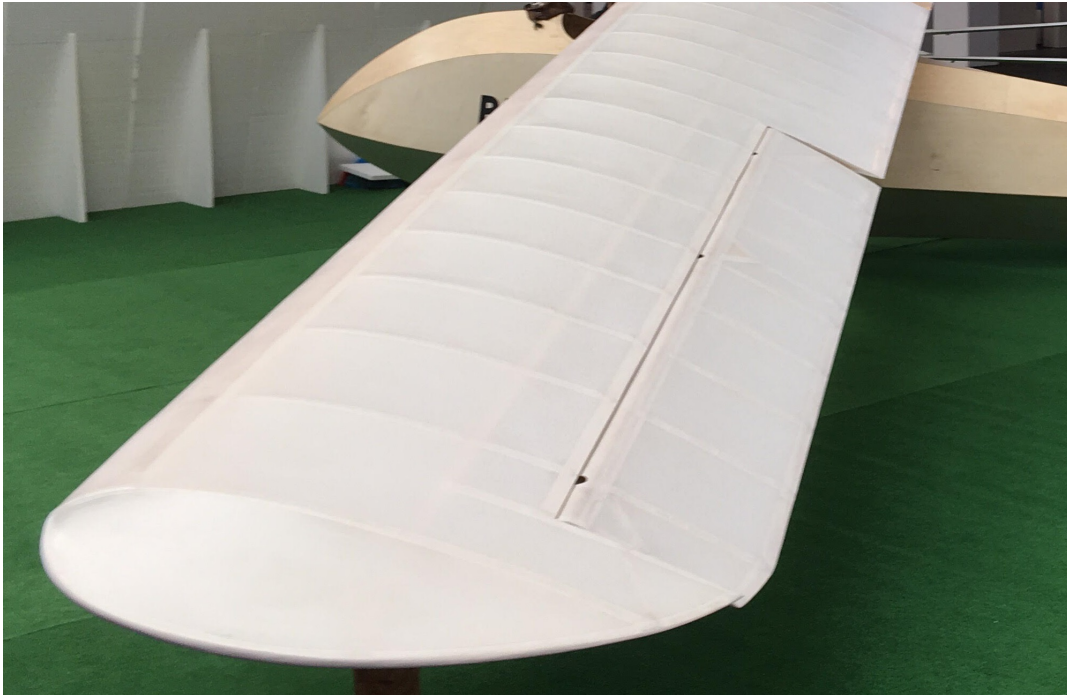
Slika 2.6: Oratex600 oplata na krilu jedrilice
