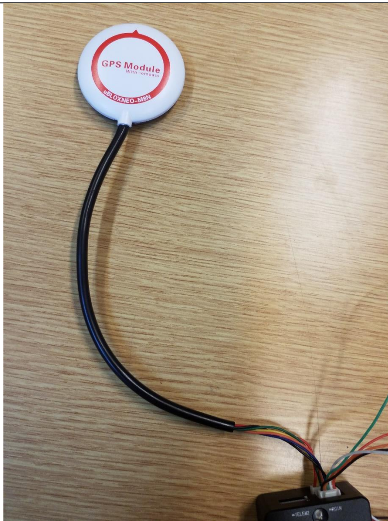
Slika 21. NEO-M8 GPS modul
