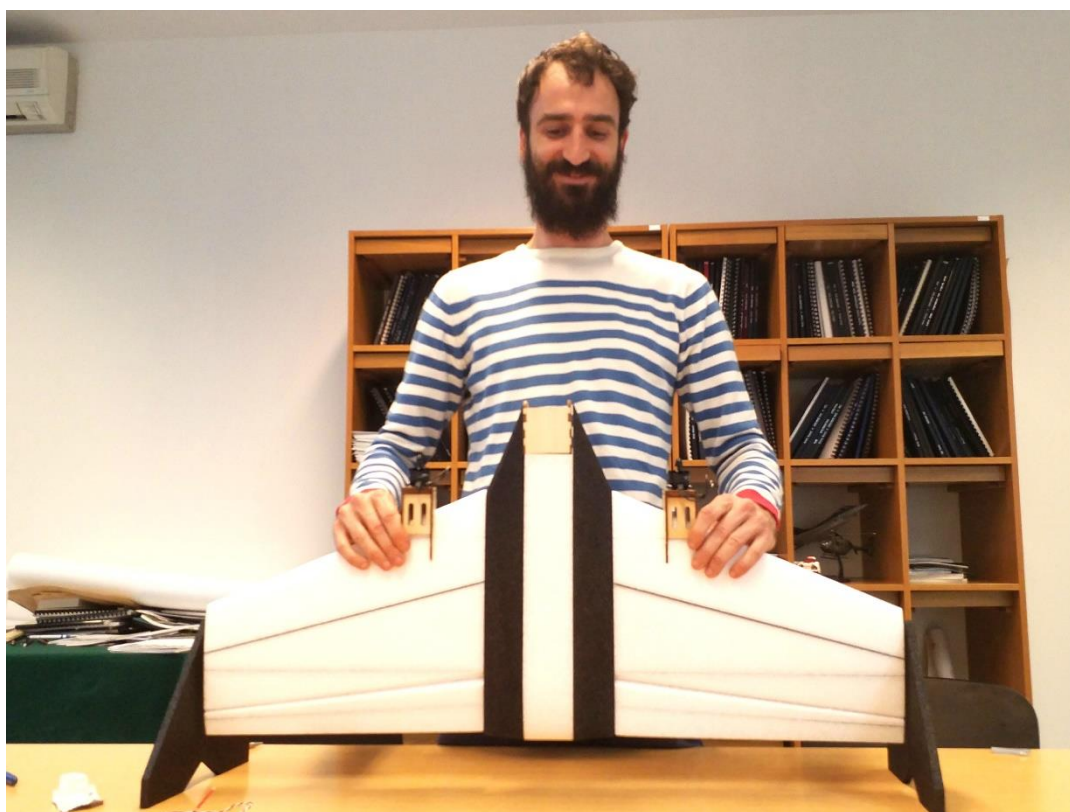
Slika 27. Razvoj VTOL polu-autonomnog letećeg krila
