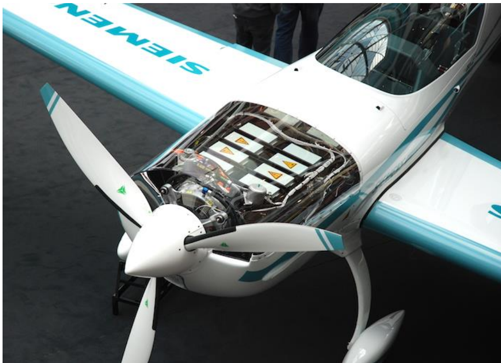
Slika 7. Pogonski sustav zrakoplova Extra 330LE [1]
