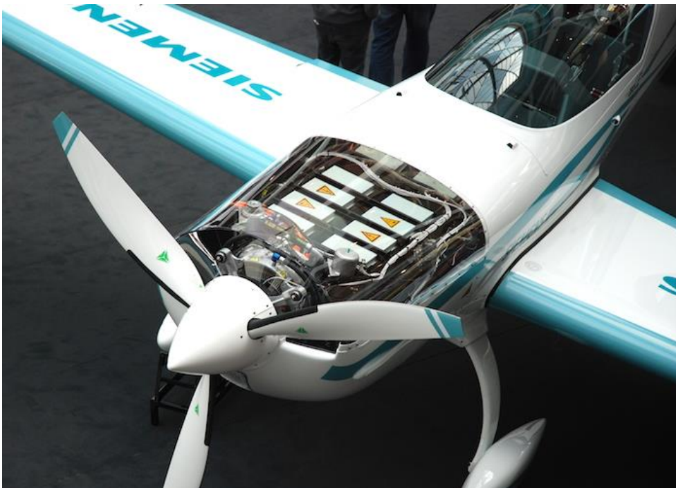
Slika 7. Pogonski sustav zrakoplova Extra 330LE [1]
