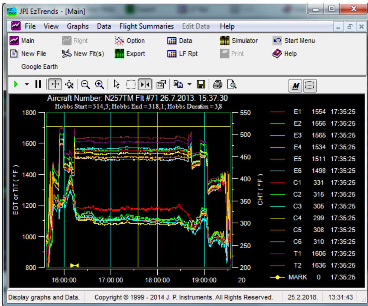
Slika 7.3. Dijagram promjene "MAIN" skupine parametara motora tijekom eksploatacije [15]
