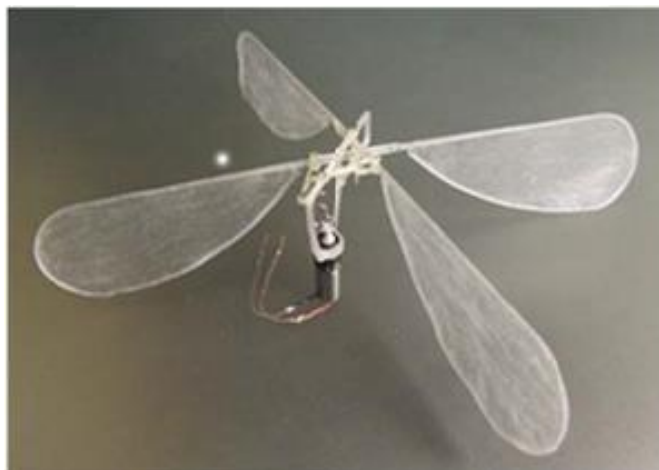
Slika 7 Mahajuće krilo proizvedeno PolyJet metodom [4]
