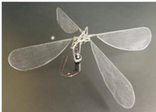
Slika 7 Mahajuće krilo proizvedeno PolyJet metodom [4]
