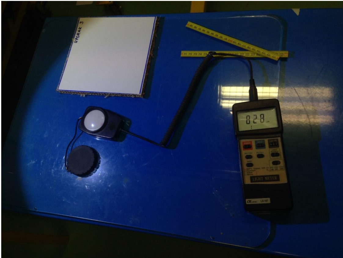
Slika 27 Mjerenje intenziteta snopa svjetlosti koji obasjava površinu ispitnog uzorka prije provođenja vizualne inspekcije
