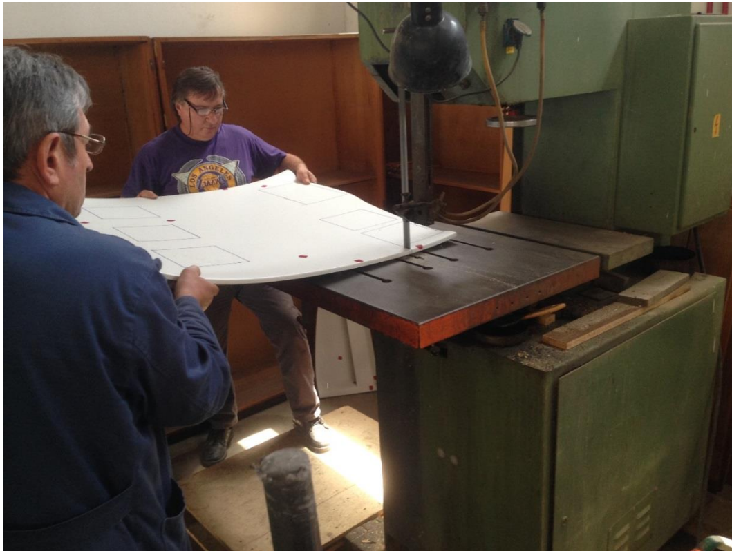
Slika 24 Rezanje panela tračnom pilom u svrhu pripreme ispitnih uzoraka uz pomoć stručnog osoblja FSB-a
