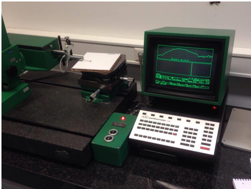
Slika 49 Mahr Perthometer S8-P s uzorkom pozicioniranim za mjerenje hrapavosti
