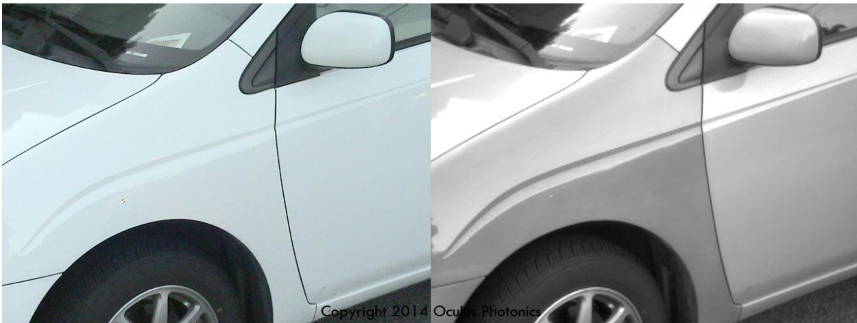
Slika 12 Slika automobila Toyota Prius s prebojanim bočnim branikom. Nova boja se manifestira kao tamnija na desnoj slici. Vizualnom metodom praktički je nemoguće uočiti razliku. [11]
