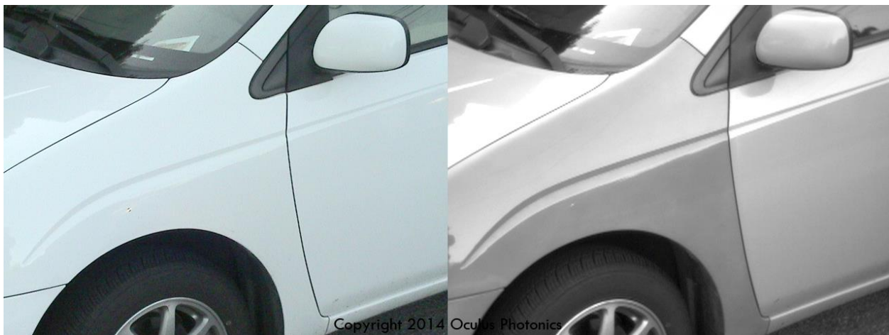
Slika 12 Slika automobila Toyota Prius s prebojanim bočnim branikom. Nova boja se manifestira kao tamnija na desnoj slici. Vizualnom metodom praktički je nemoguće uočiti razliku. [11]
