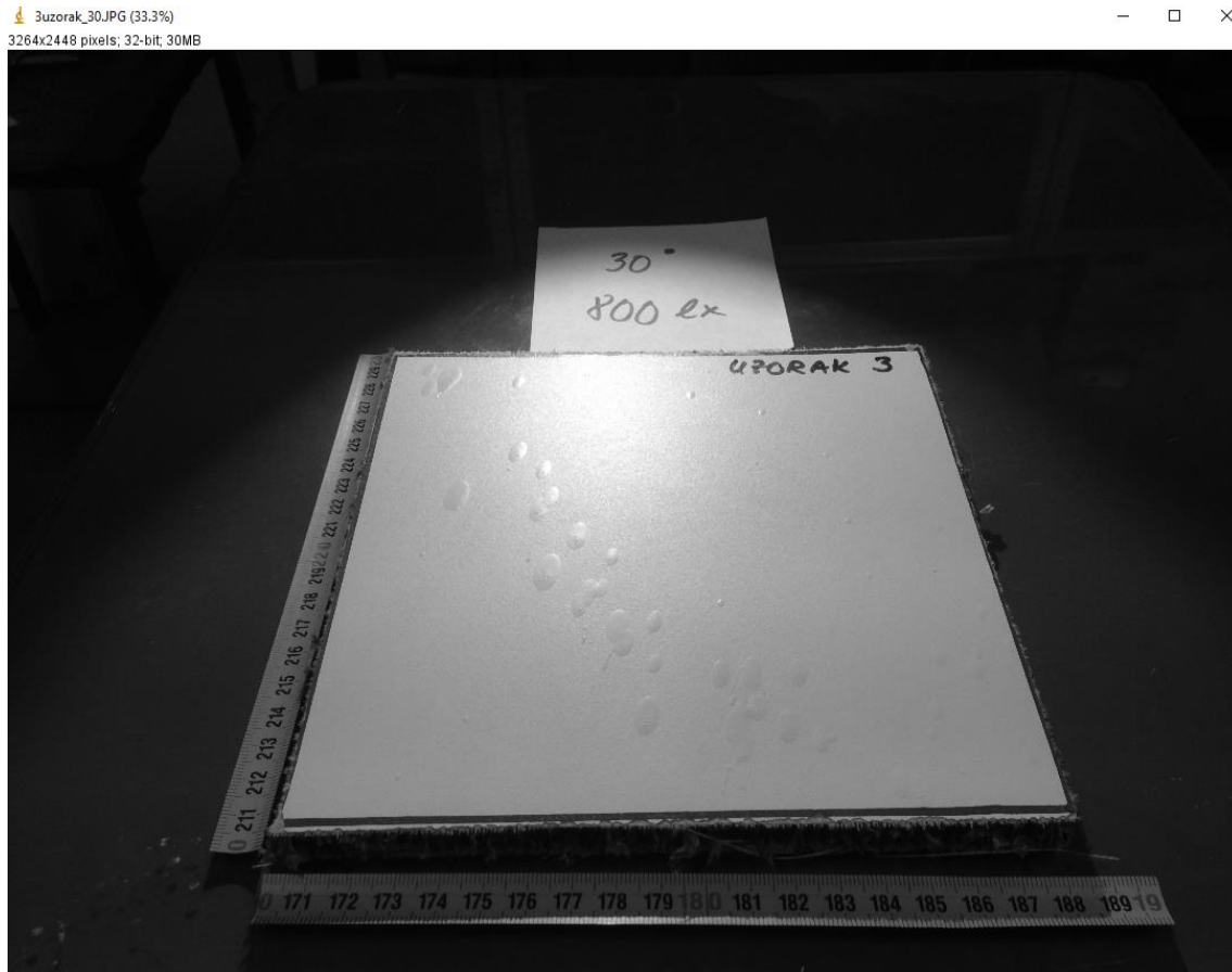
Slika 40 Uzorak 3 s upadnim kutom svjetlosti od 30^\circ u odnosu na površinu ispitnog uzorka, obrađen u ImageJ-u pomoću 32 bitnog greyscale transformatora i Median filtera
