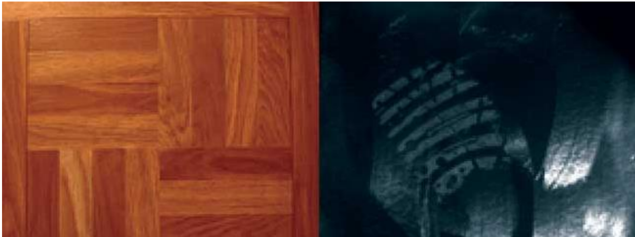
Slika 11 Voskom polirani parket s otiskom cipele. Na lijevoj slici, uzorak je osvijetljen danjim svjetlom, te se vidi samo mali trag cipele točno na sredini slike, dok je na desnoj slici isti uzorak obasjan UV svjetlošću. [11]
