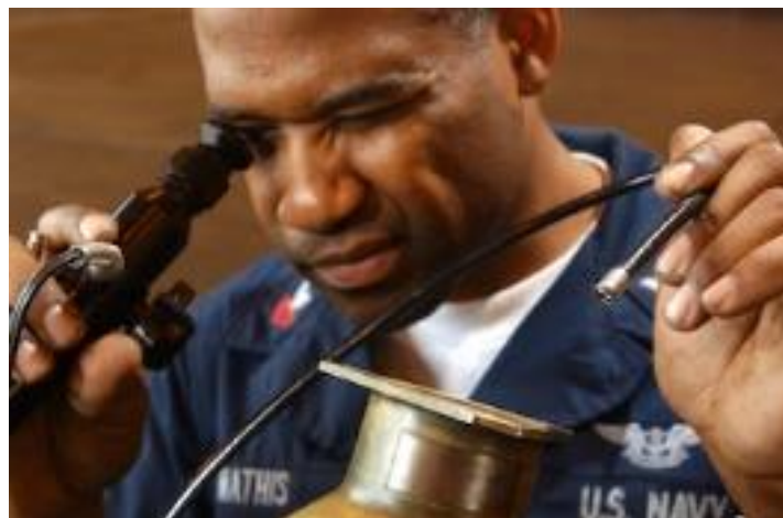
Slika 1 Inspektor prilikom provođenja vizualne metode [1]
