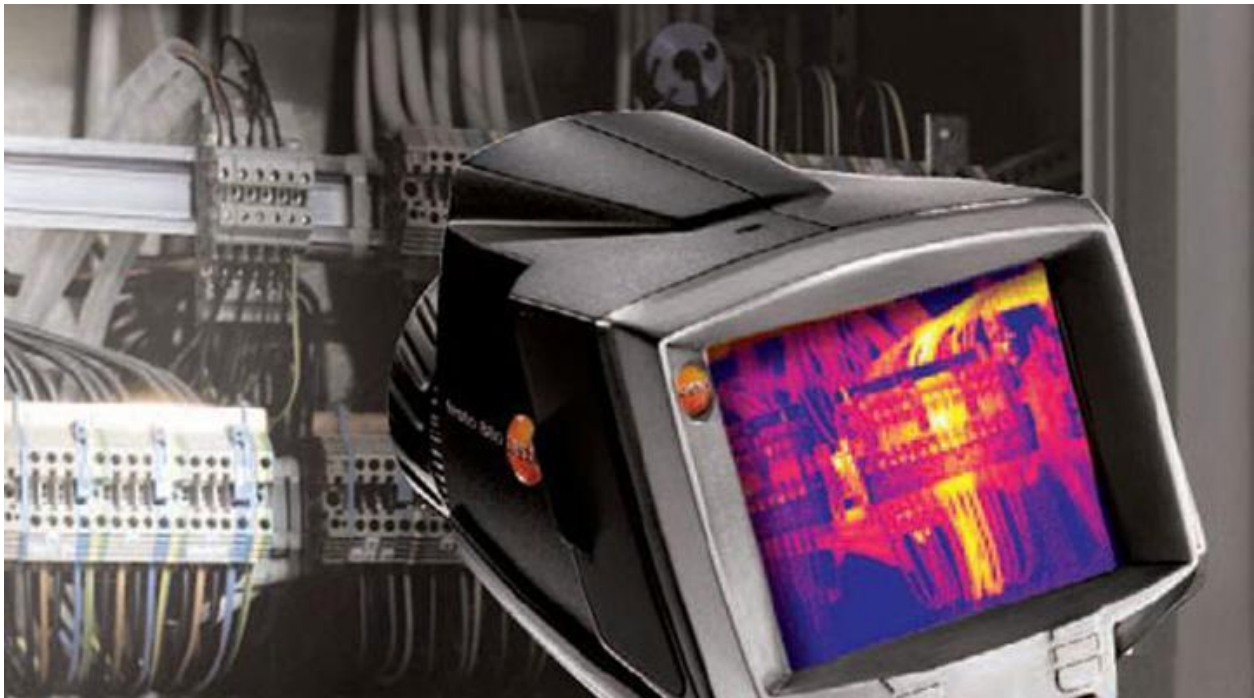
Slika 5 Termogram na kojem se vide boje koje korespondiraju razlikama u temperaturi [3]
