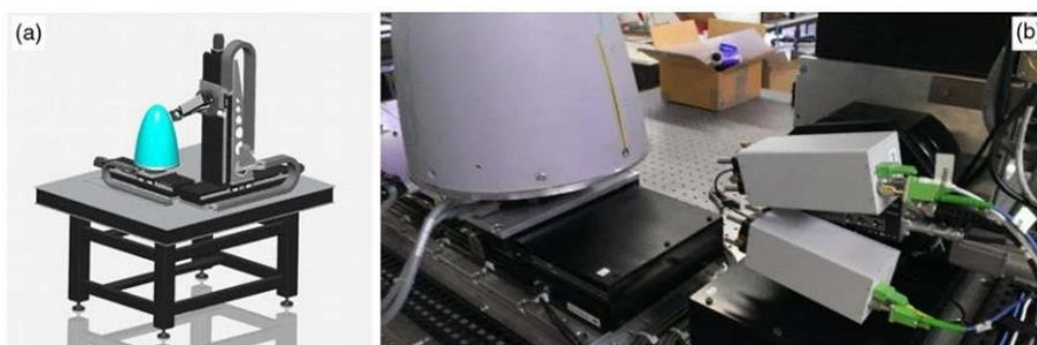
Slika 17 Sustav za terahertz spektroskopsko ispitivanje [15]
