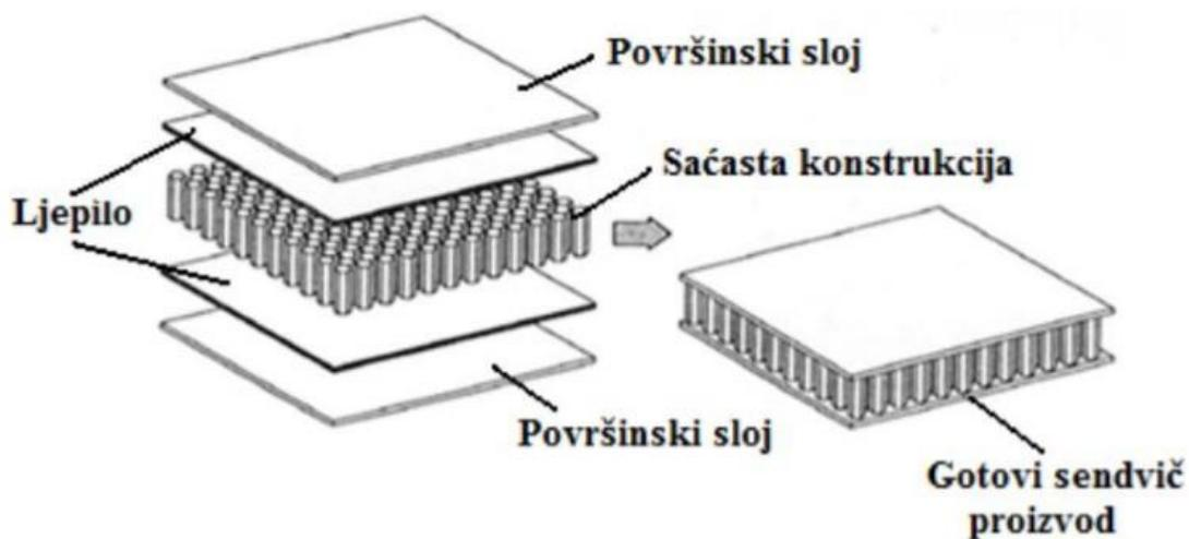
**Slika 22. Shematski prikaz strukture koja se sastoji od površinskih slojeva i jezgre u obliku sača [20]**
