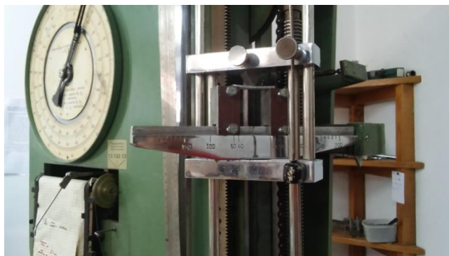
Slika 37. Uzorak oslonjen u tri točke na kidalici
