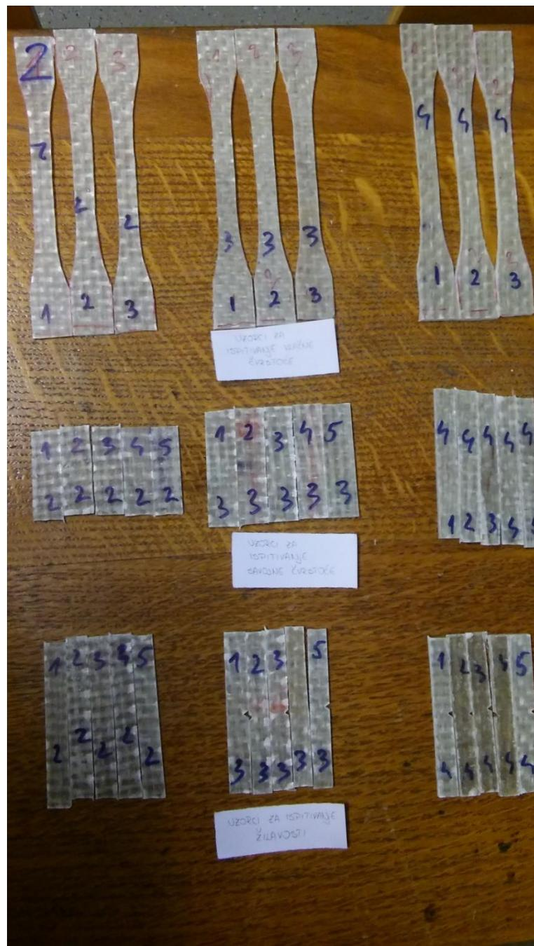
Slika 34. Numeriranje uzoraka kompozita
