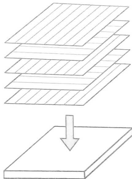
**Slika 21.** Slaganje različito usmjerenim vlaknima ojačanih slojeva kod slojevitih kompozita [20]
