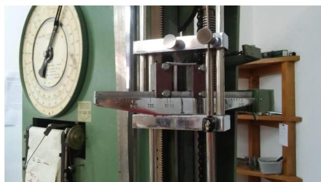
Slika 37. Uzorak oslonjen u tri točke na kidalici
