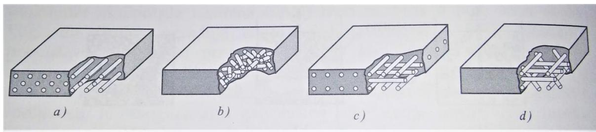
**Slika 23. Osnovni načini rasporeda vlaknatih ojačala: a) kontinuirana jednosmjerna vlakna, b) slučajno usmjerena diskontinuirana vlakna, c) ortogonalno raspoređena vlakna, d) višesmjerno položena vlakna [20]**
