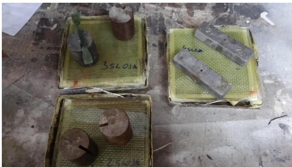
Slika 32. Opterećeni komadi kompozita
