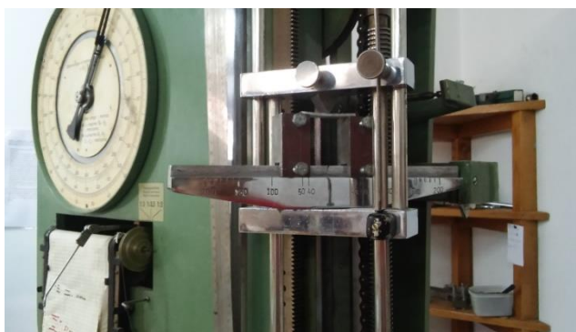
Slika 37. Uzorak oslonjen u tri točke na kidalici
