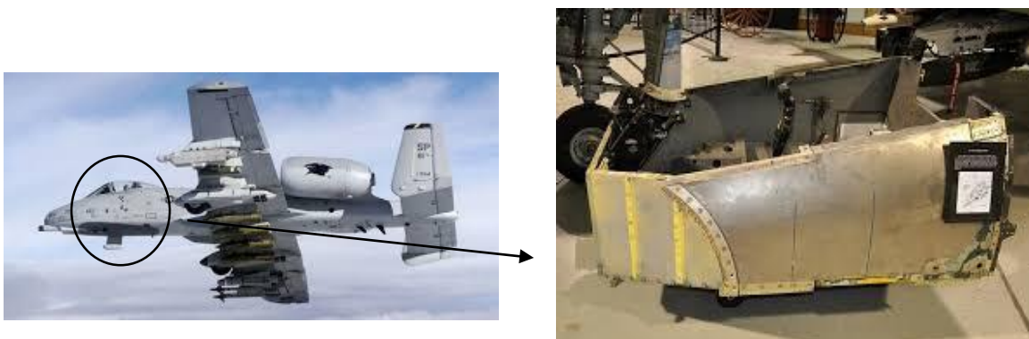
Slika 3. Titanski oklop oko sjedala pilota na zrakoplovu A-10 Thunderbolt II
