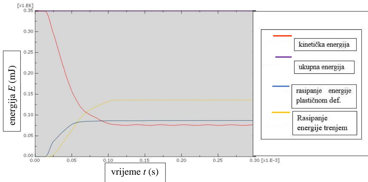
Slika 31. Prikaz promjena energija tijekom udara projektila pod kutom udara od  $10^\circ$  i početnom brzinom projektila od  $450 \text{ m/s}$  u Al ploču debljine  $5 \text{ mm}$
