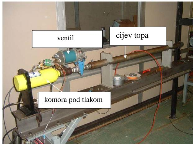
Slika 8. Eksperimentalni postav za ispitivanje probijanja [13]
