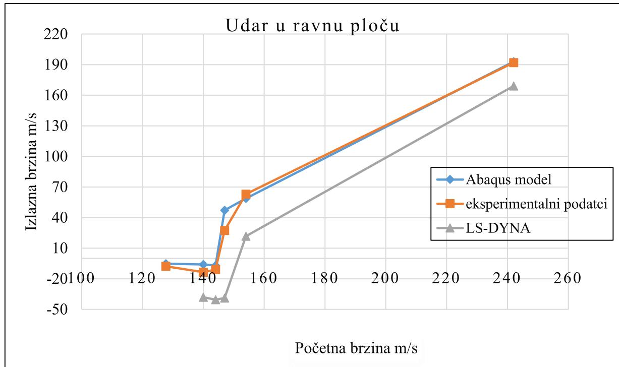
Slika 15. Usporedba rezultata udara u ravnu ploču
