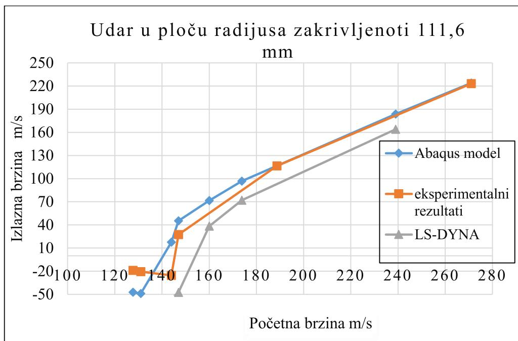
Slika 16. Usporedba rezultata udara u ploču zakrivljenosti 111,6 mm
