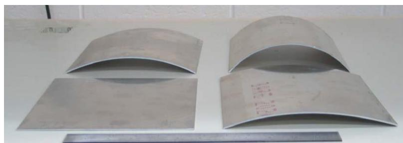
Slika 9. Uzorci ravne ploče, ploča radijusa zakriviljenosti 304,8 mm, ploča radijusa zakriviljenosti 203,2 mm i ploča radijusa zakriviljenosti 111,76 mm [13]
