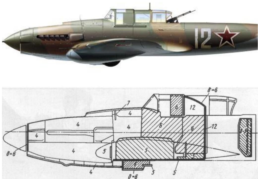
Slika 1. Il-2 Šturmovik s označenim područjima koja su zaštićeni oklopom od čelika, brojevi na slici označuju debjinu zaštite u mm [2]
