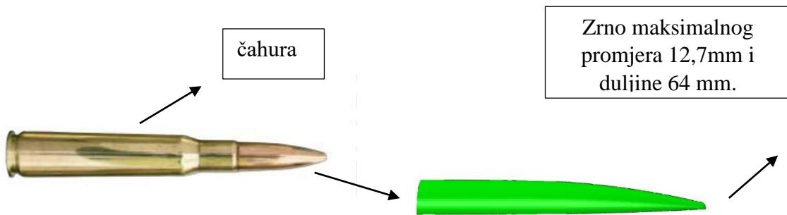
Slika 20. Kalibar 12,7 x 99 mm [17] te njegov CAD model
