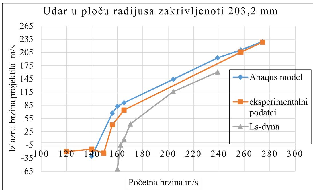
Slika 17. usporedba rezultata na ploči radijusa zakrivljenosti 203,6 mm
