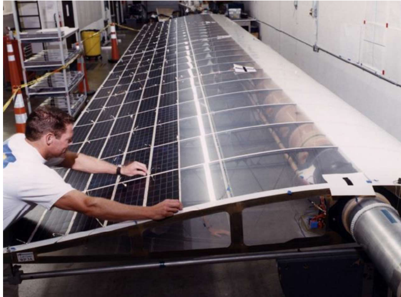
Slika 2.7 Postavljanje solarnih ćelija na Helios solarnu letjelicu [9]
