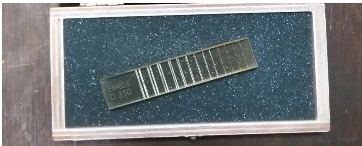
Slika 15: Duplex indikator prema normi EN 462-5
