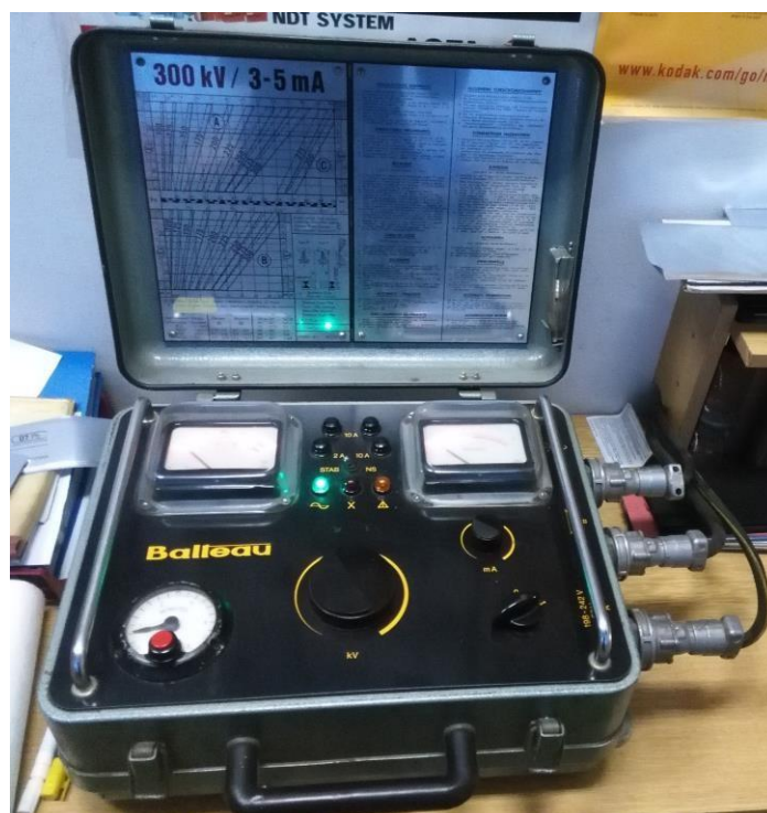
Slika 11: Upravljačka jedinica rendgenske cijevi
