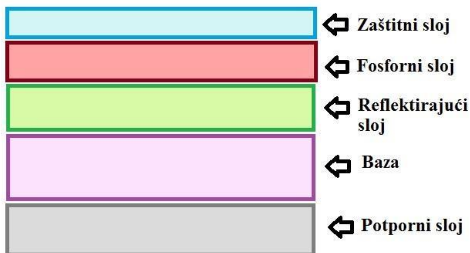
Slika 1: Prikaz slojeva slikovne ploče [5]
