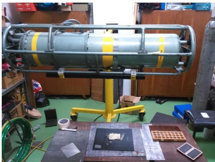
Slika 10: Rendgenska cijev na nosaču postavljena na 700 mm visine
