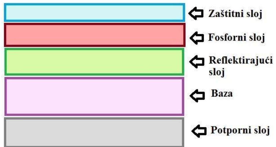
Slika 1: Prikaz slojeva slikovne ploče [5]
