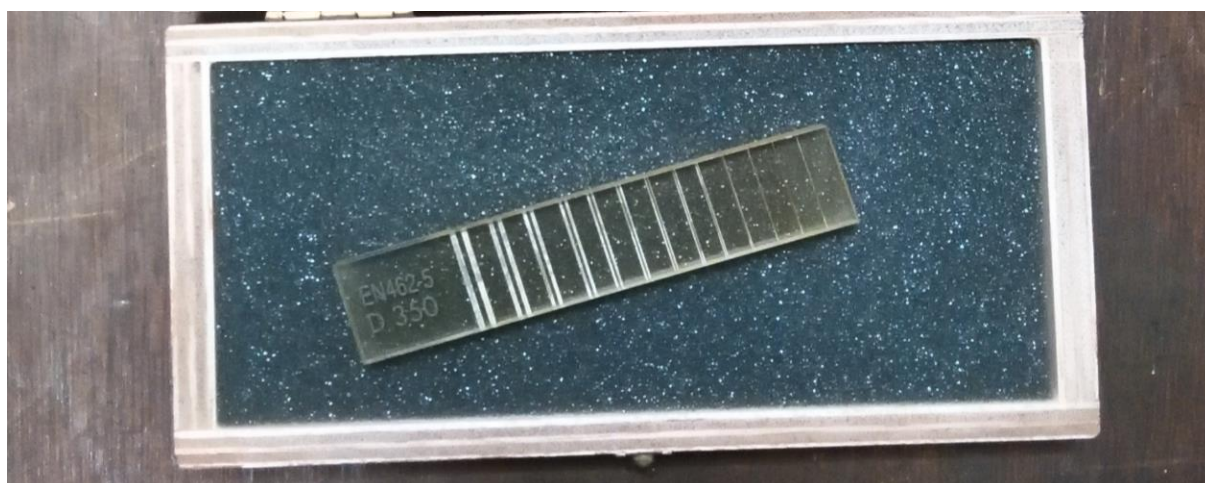
Slika 15: Duplex indikator prema normi EN 462-5
