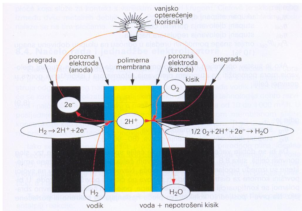
Slika 5.1. Princip rada gorivne čelije [8]
