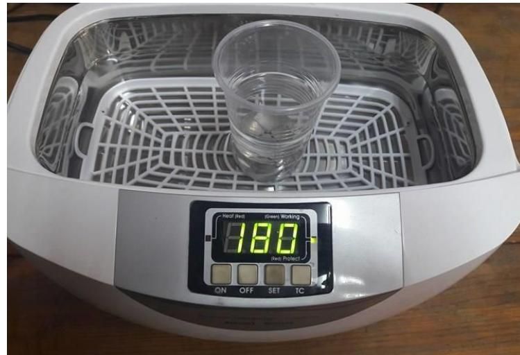
Slika 23 Otklanjanje nečistoća u ultrazvučnoj kadi
