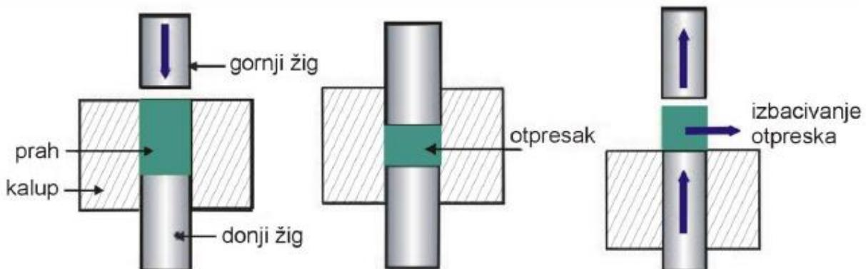
**Slika 10 Postupak jednoosnog kompaktiranja u kalupu [4]**
