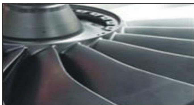
Slika 16 Dijelovi turbine od sinterirane legure titana [5]
