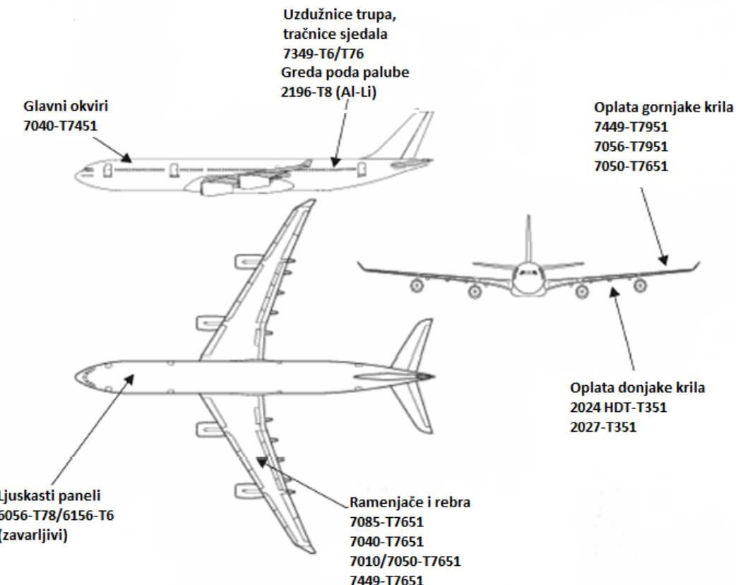
Slika 1 Dijelovi zrakoplova izrađeni od Al-legura [3]
