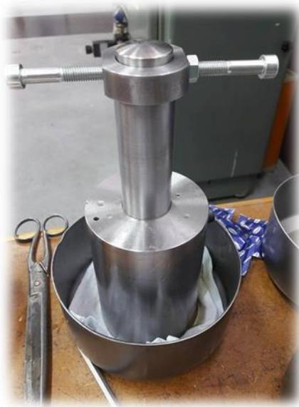
Slika 20 Alat za odstranjivanje viška zraka i ulja
