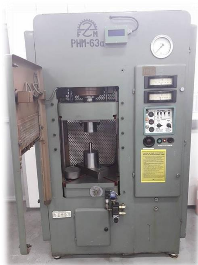
Slika 21 Uređaj za CIP
