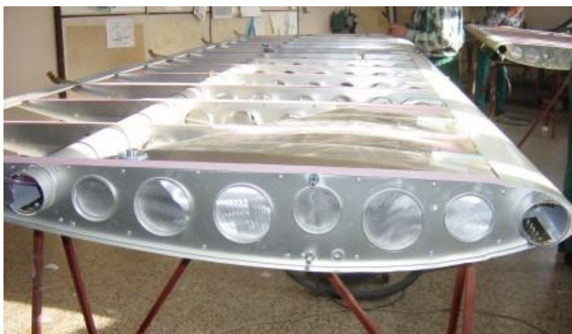
Slika 3 Dijelovi krila izrađeni od legura 7XXX [9]
