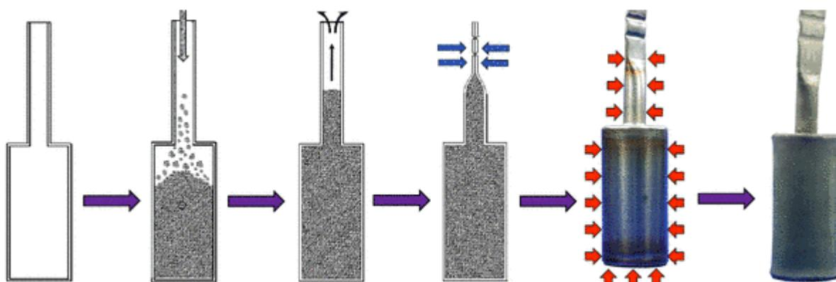
Slika 12 Shematski prikaz postupka toplog izostatskog prešanja [5]
