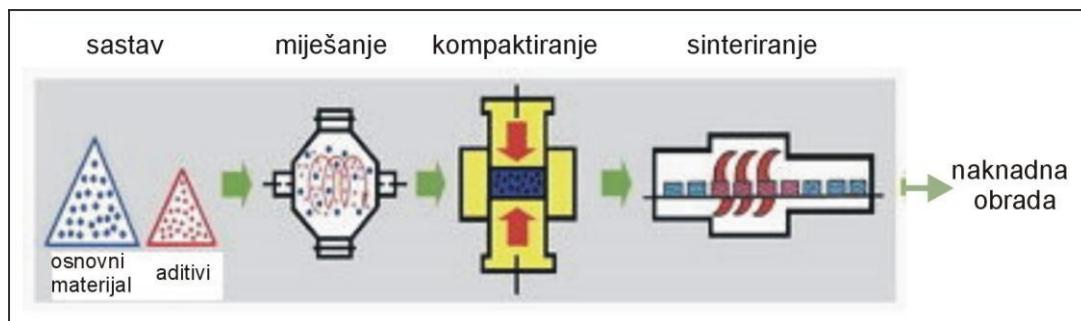
**Slika 4 Osnovne tehnološke operacije konvencionalnih postupaka metalurgije praha [5]**
