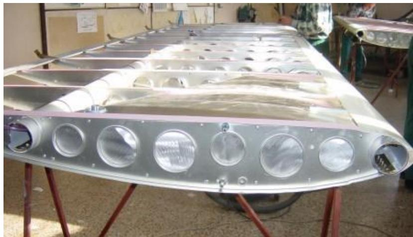
Slika 3 Dijelovi krila izrađeni od legura 7XXX [9]
