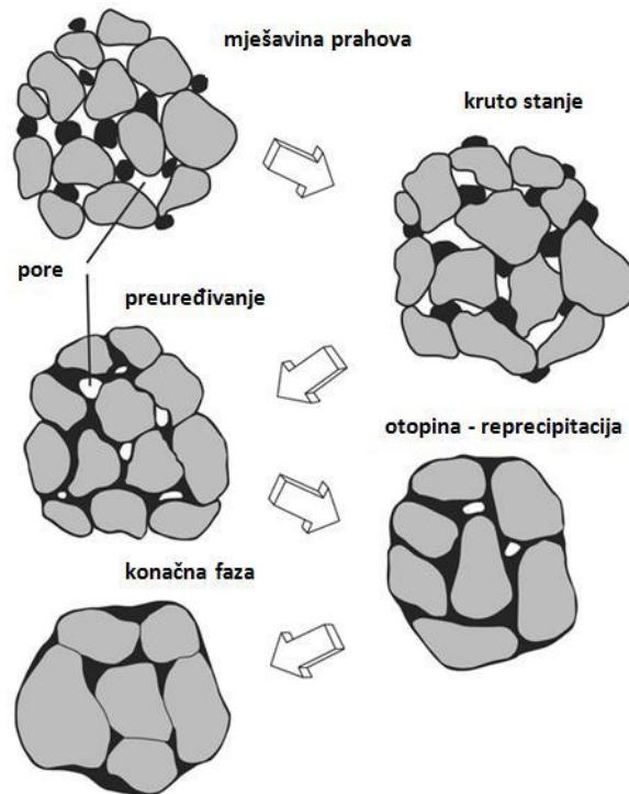
Slika 14 Faze konsolidacije tijekom sinteriranja u tekućoj fazi [4]
