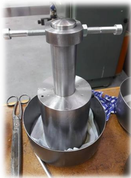
Slika 20 Alat za odstranjivanje viška zraka i ulja
