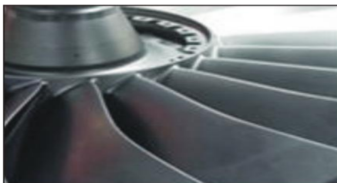
Slika 16 Dijelovi turbine od sinterirane legure titana [5]
