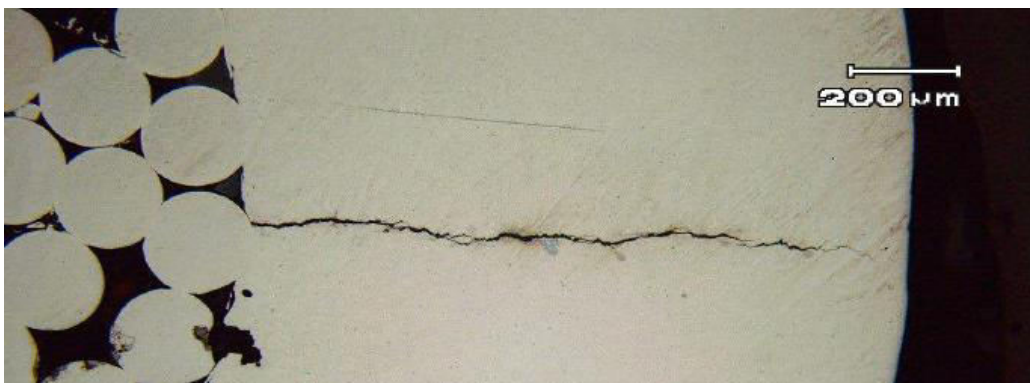
Slika 13: Detaljniji prikaz napetosne korozije kabla za upravljačke površine, čelik AISI 304. Vidljivo je da pukotina još nije potpuno perforirala stijenku materijala [32].
