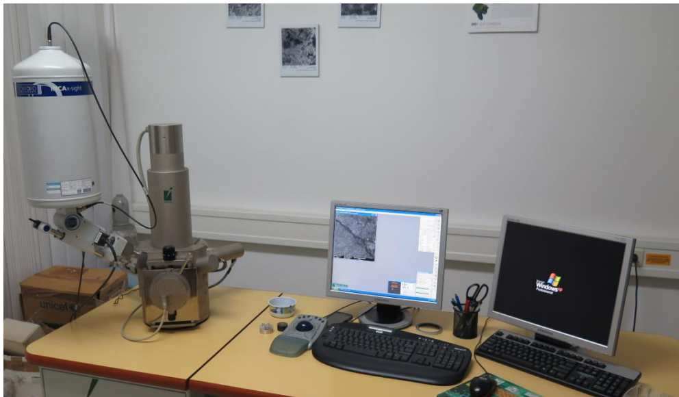
Slika 25: Skenirajući elektronski mikroskop (SEM) – Laboratorij za materijalografiju FSB-a.
