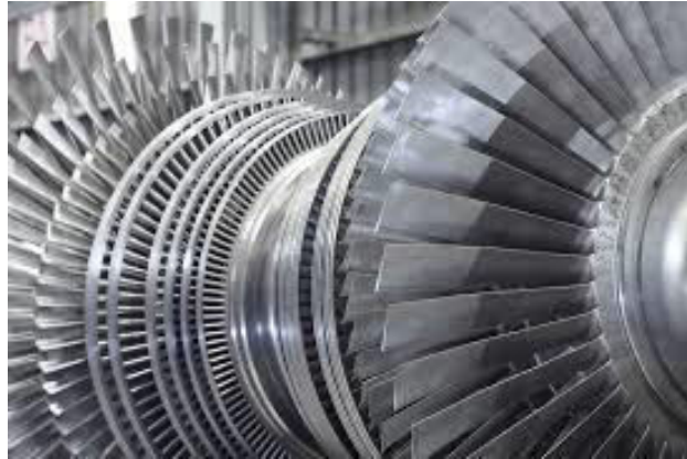
Slika 6: Turbinske lopatice napravljene od martenzitnog nehrđajućeg čelika [13].
