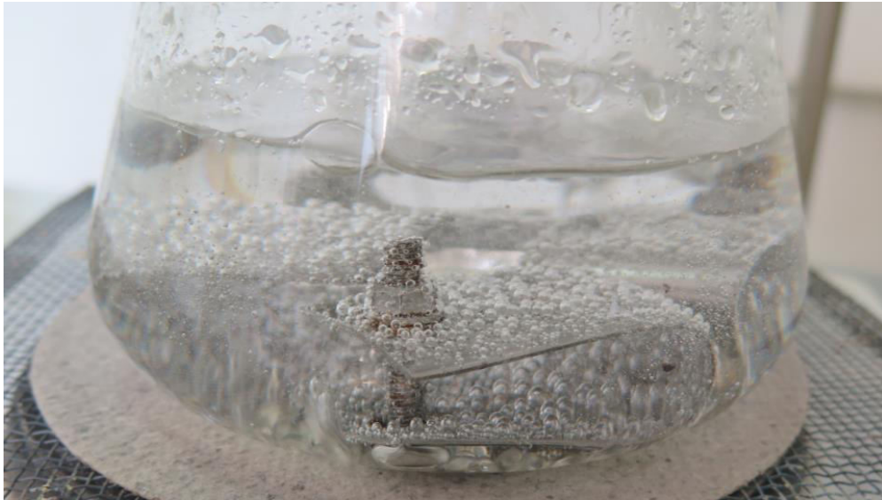
Slika 23: Detaljniji prikaz provedbe korozivskog ispitivanja. Snimljeno tijekom ispitivanja uzoraka od austenitnih čelika.
