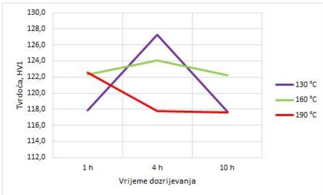
Slika 39. Dijagramski prikaz ovisnosti tvrdoće o vremenu dozrijevanja
