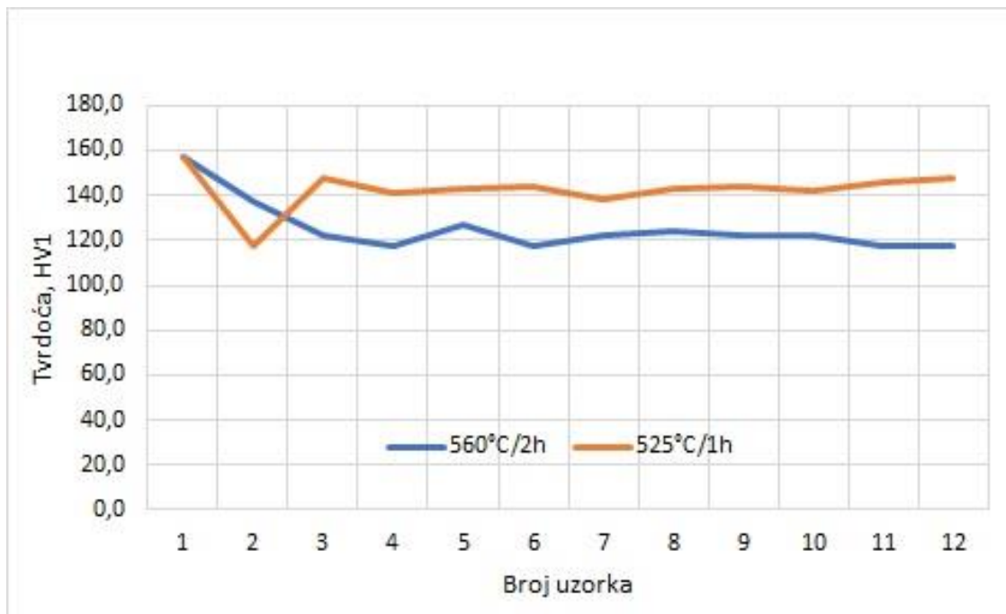
Slika 40. Usporedba tvrdoće uzoraka homogeniziranih na različitim temperaturama i trajanju
