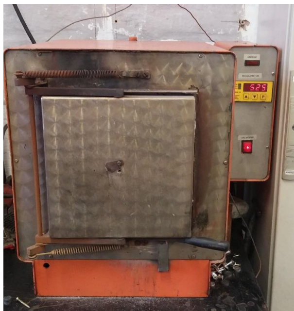
Slika 27. Elektropeć-otporna peć za toplinsku obradu
