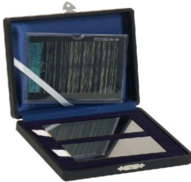
Slika 3. Radni etalon tipa 1
