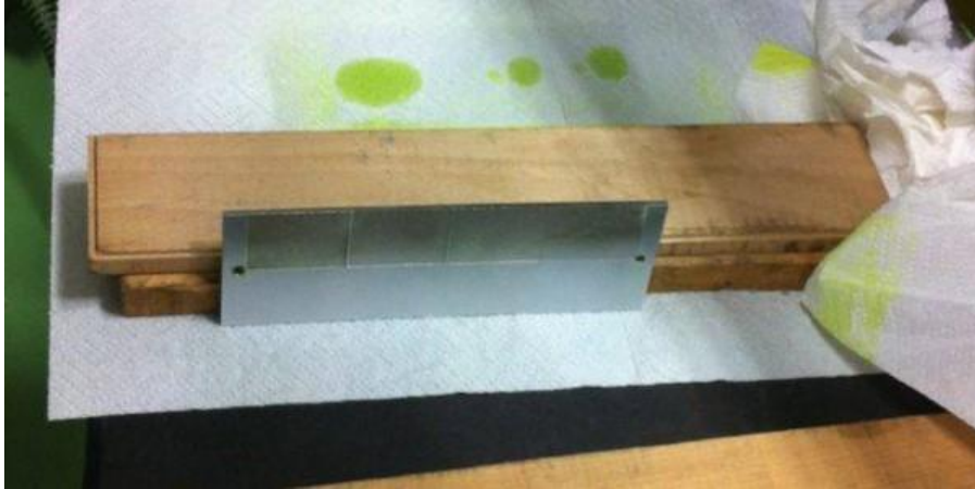
Slika 12. Nanešeni razvijaač i razvijanje penetranta kad je etalon postavljen na bočnu stranu
