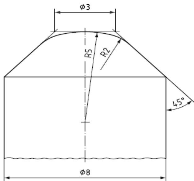
*Slika 6. Izgled alata za izradu nepravilnosti u obliku zvijezda [7]*
