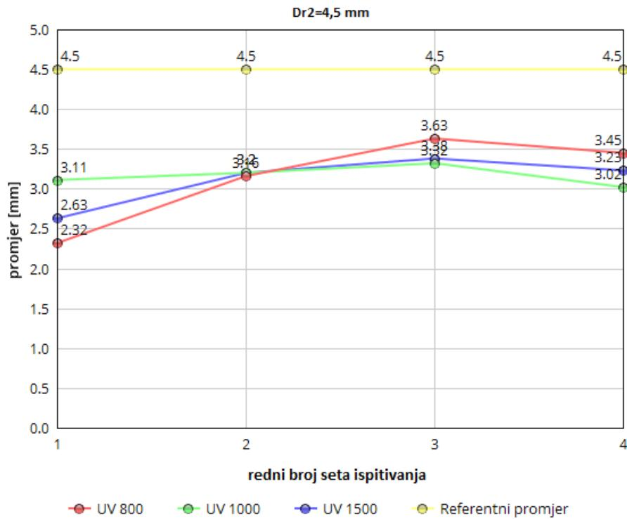
Slika 33. Grafički prikaz izmjerene vrijednosti zajedno s referentnom vrijednošću promjera nepravilnosti od 4,5 mm
