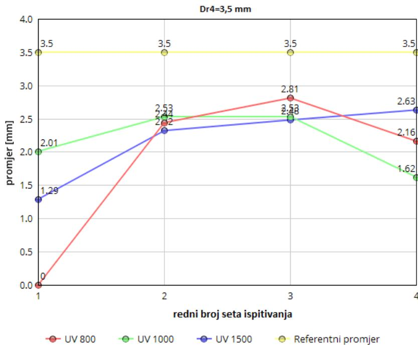
*Slika 35. Grafički prikaz izmjerениh vrijednosti zajedno s referentnom vrijednošću promjera nepravilnosti od 3,5 mm*
