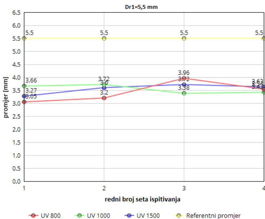
Slika 32. Grafički prikaz izmjerene vrijednosti zajedno s referentnom vrijednošću promjera nepravilnosti od 5.5 mm
