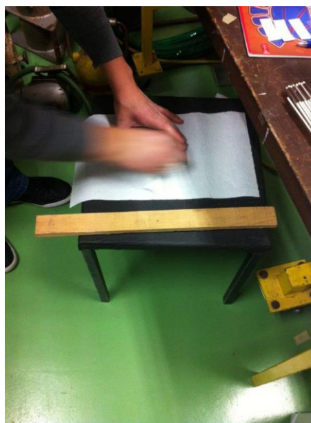
Slika 11. Uklanjanje viška penetranta s površine etalona
