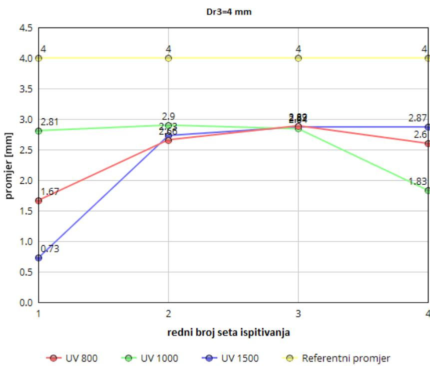
Slika 34. Grafički prikaz izmjerene vrijednosti zajedno s referentnom vrijednošću promjera nepravilnosti od 4 mm
