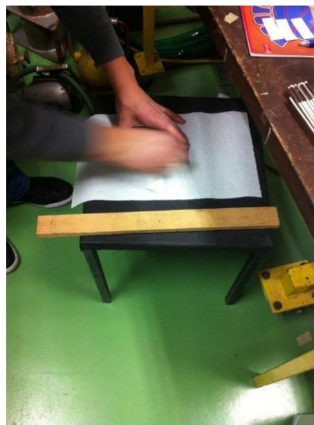
Slika 11. Uklanjanje viška penetranta s površine etalona
