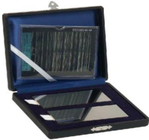
*Slika 3. Radni etalon tipa I*
