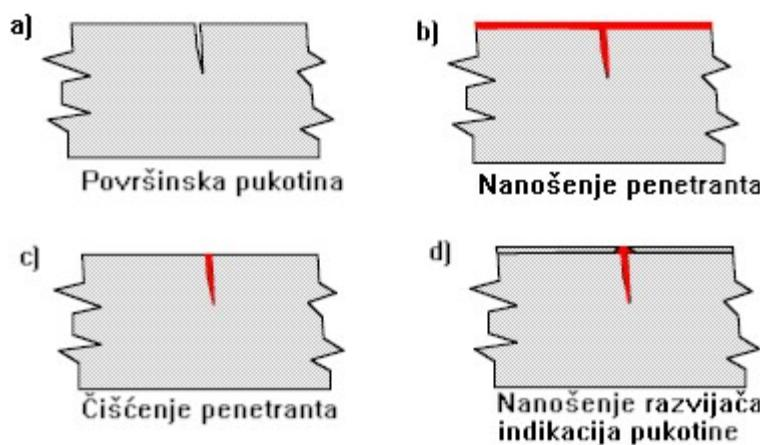
Slika 1. Osnovni postupak ispitivanja penetrantima
