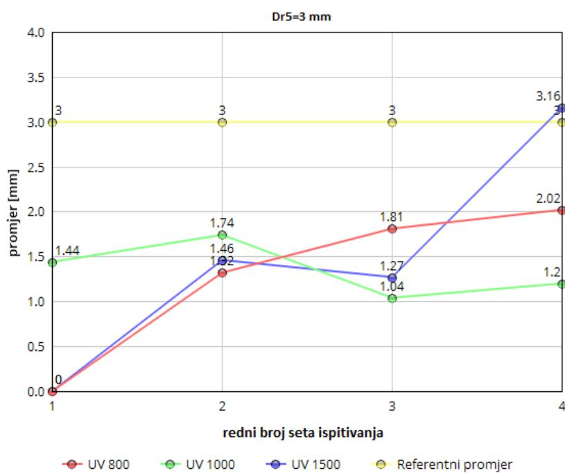
*Slika 36. Grafički prikaz izmjerениh vrijednosti zajedno s referentnom vrijednošću promjera nepravilnosti od 3 mm*
