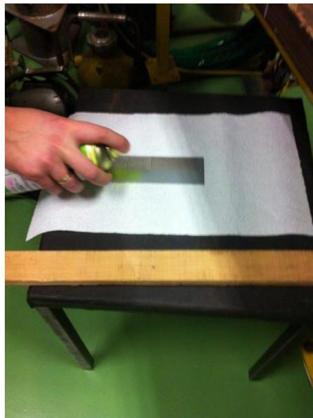
Slika 10. Nanošenje penetranta
