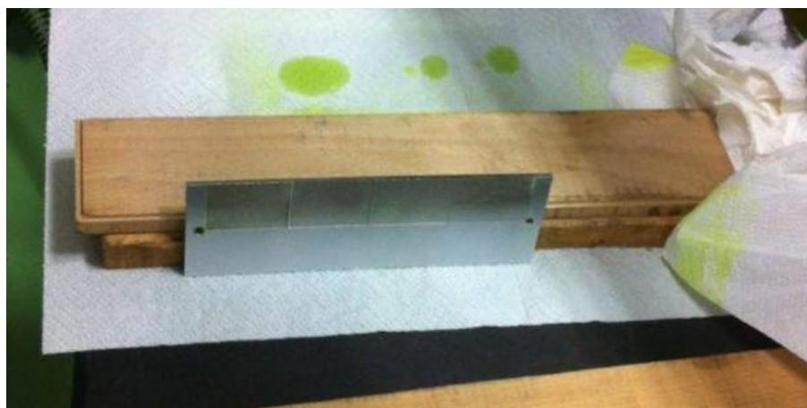
*Slika 12. Nanešeni razvijač i razvijanje penetranta kad je etalon postavljen na bočnu stranu*
