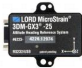
Slika 2.6: Odabrana inercijska mjerna jedinica 3DM-GX3-25 Microstrain [16]
