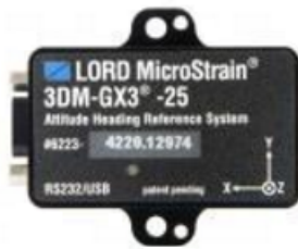
Slika 2.6: Odabrana inercijska mjerna jedinica 3DM-GX3-25 Microstrain [16]
