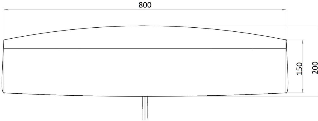
Slika 2.9: Horizontalni stabilizator. Dimenzije su u [mm].
