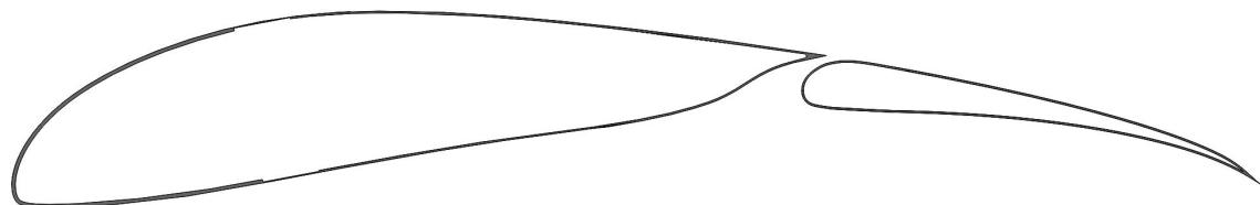
Slika 2.1: Presjek modificiranog S1223 profila sa zakrilcem s procjepom
