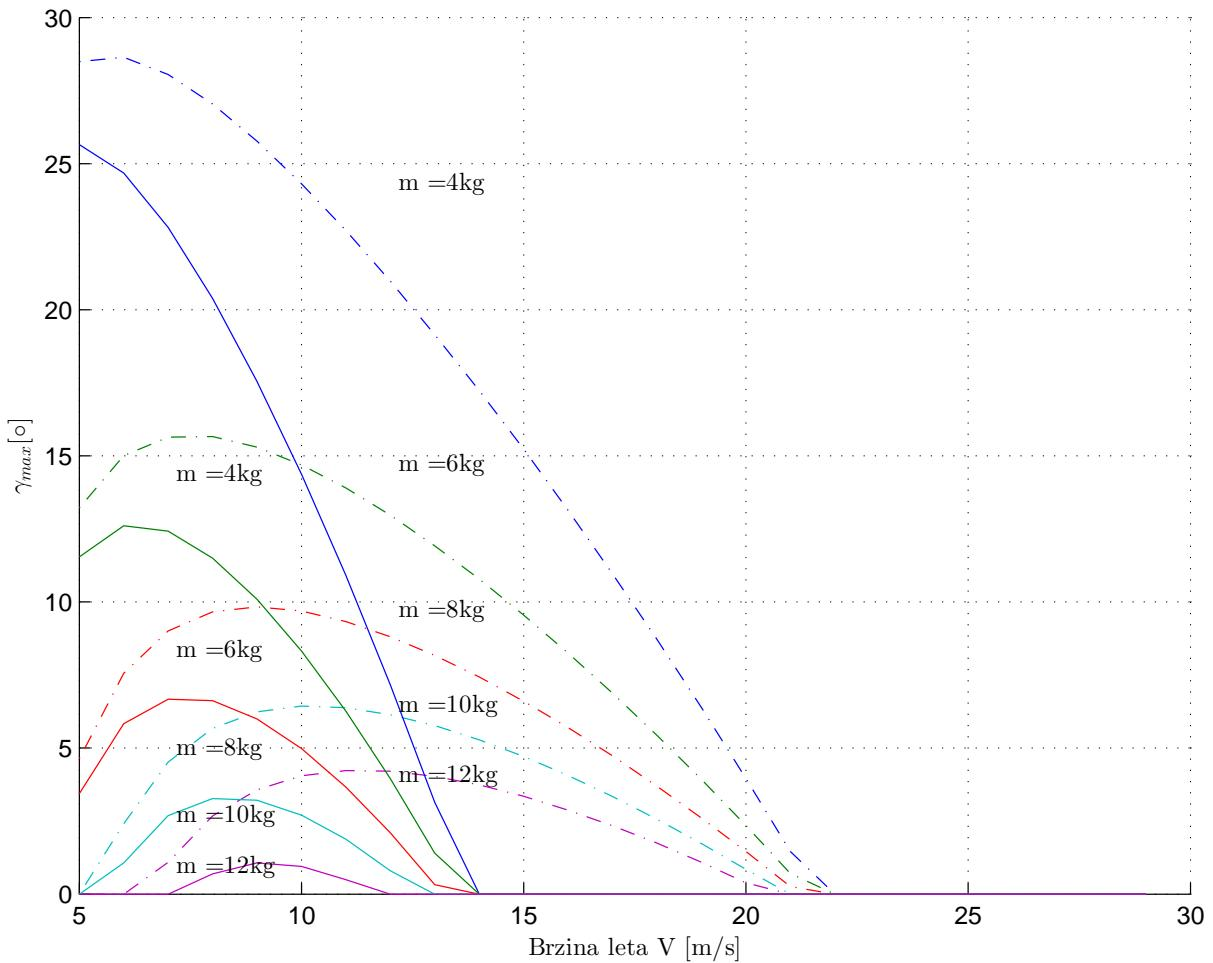
Slika 5.13: Maksimalni napadni kut ovisno o brzini leta za različite mase letjelice i dva različita koeficijenta nultog otpora  $C_{D0} = 0.0459$  (isprikidane linije) i  $C_{D0} = 0.1424$  (pone linije)
