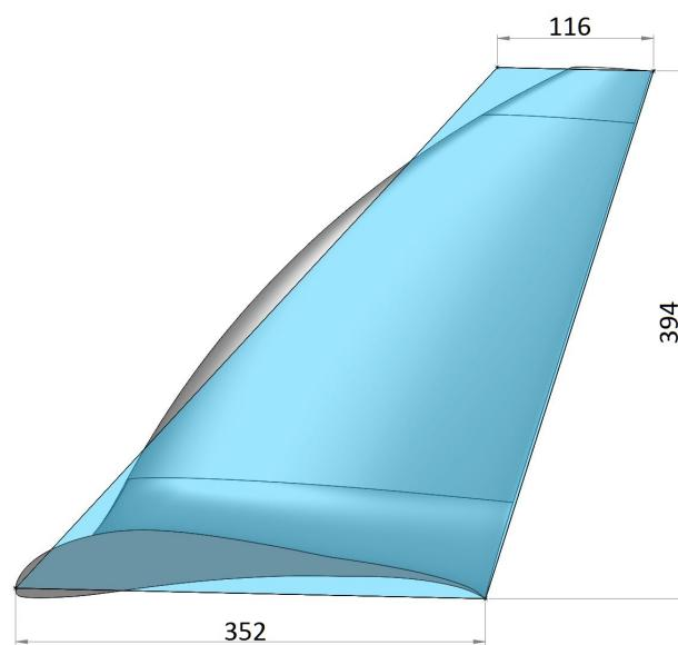
Slika 2.7: Pojednostavljena (trapezna) geometrija završetka krila (plavo) i stvarna geometrija završetka krila (sivo). Dimenzije su u [mm].
