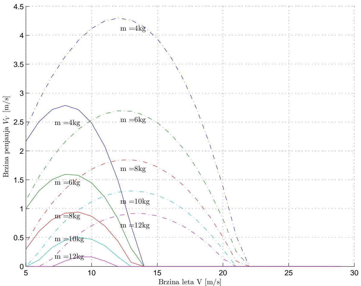
Slika 5.19: Maksimalna brzina penjanja ovisno o brzini leta za različite mase letjelice i dva različita koeficijenta nultog otpora letjelice  $C_{D0} = 0.0459$  (isprekidane linije) i  $C_{D0} = 0.1424$  (pune linije)
