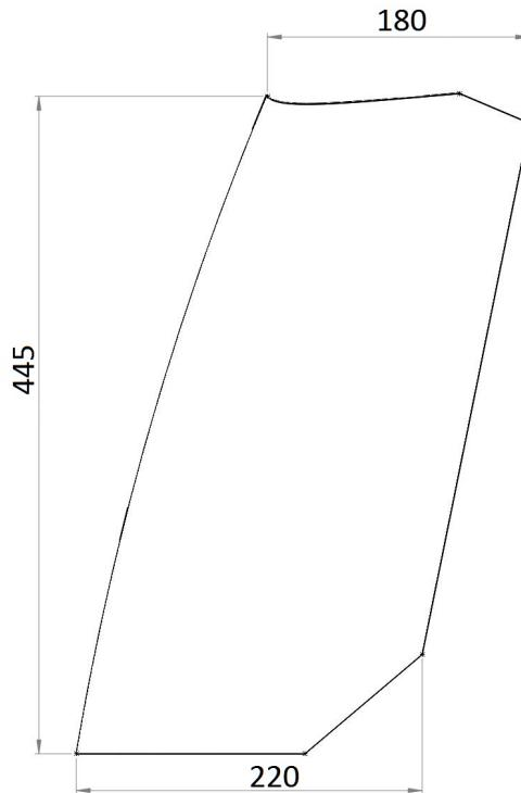
Slika 2.10: Vertikalni stabilizator. Dimenzije su u [mm].
