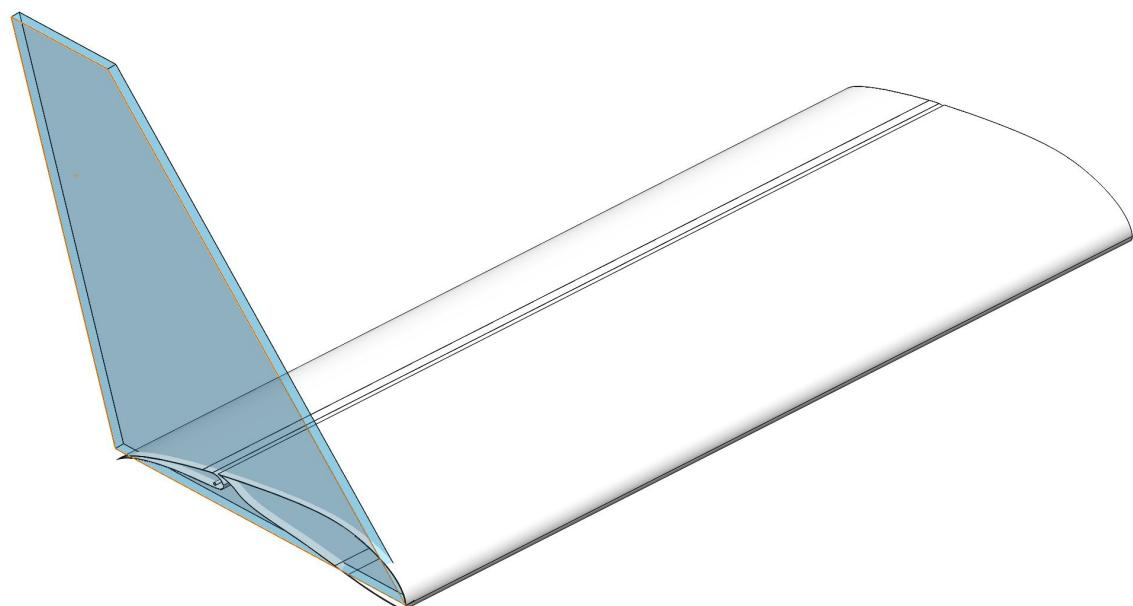
Slika 2.8: Vanjski segment krila (bijelo) sa pojednostavljenom (trapeznom) geometrijom završetka krila (plavo)
