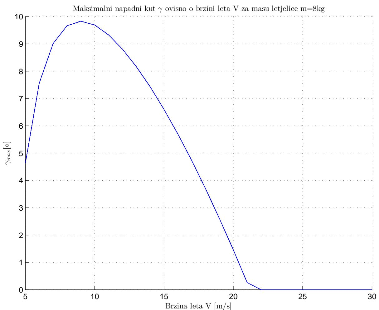
Slika 5.11: Maksimalni napadni kut ovisno o brzini leta za masu letjelice m=8kg i koeficijent nultog otpora  $C_{D0} = 0.0459$
