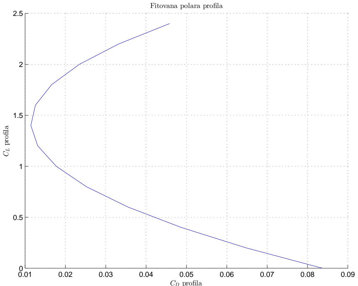
Slika 3.13: Aproksimacija rezultata iz xflr-a polinomom drugog stupnja za različite brzine strujanja i opseg napadnih kutova od  $\alpha = -4 : +16^\circ$
