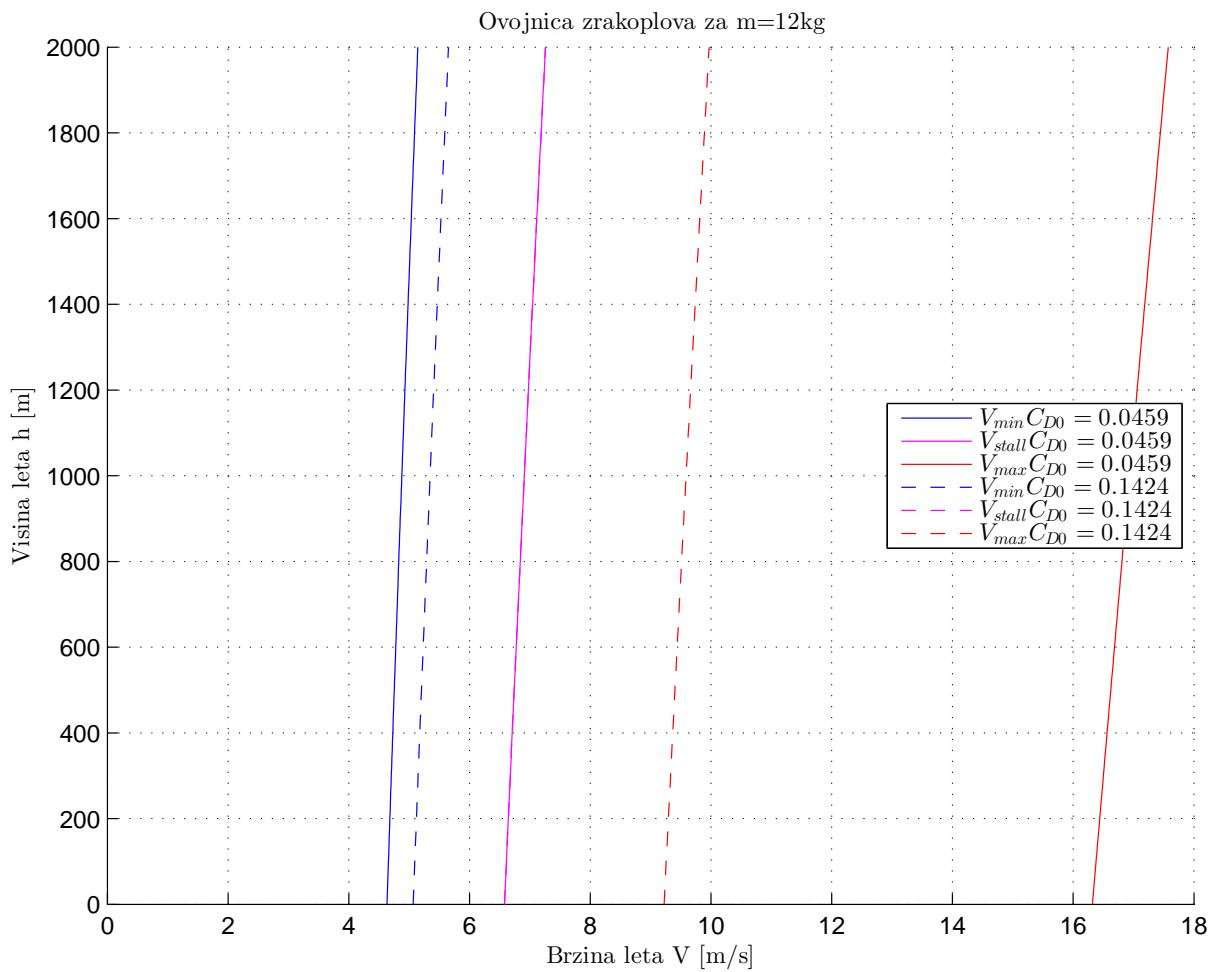
Slika 5.2: Ovojnica leta za dva koeficijenta nultog otpora letjelice  $C_{D0} = 0.0459$  i  $C_{D0} = 0.1424$  i masu letjelice  $m=12\text{kg}$
