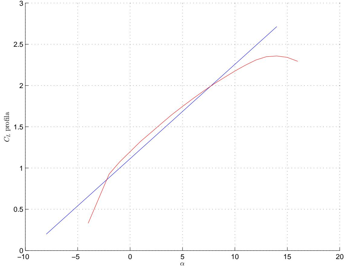
Slika 3.12: Usporedba koeficijenata sile uzgona profila  $c_l$  dobivenog aproksimacijom s polinomom prvog stupnja (plavo) i dobivenog u xflr-u za briznu strujanja  $V = 28$  [m/s] (crveno)
