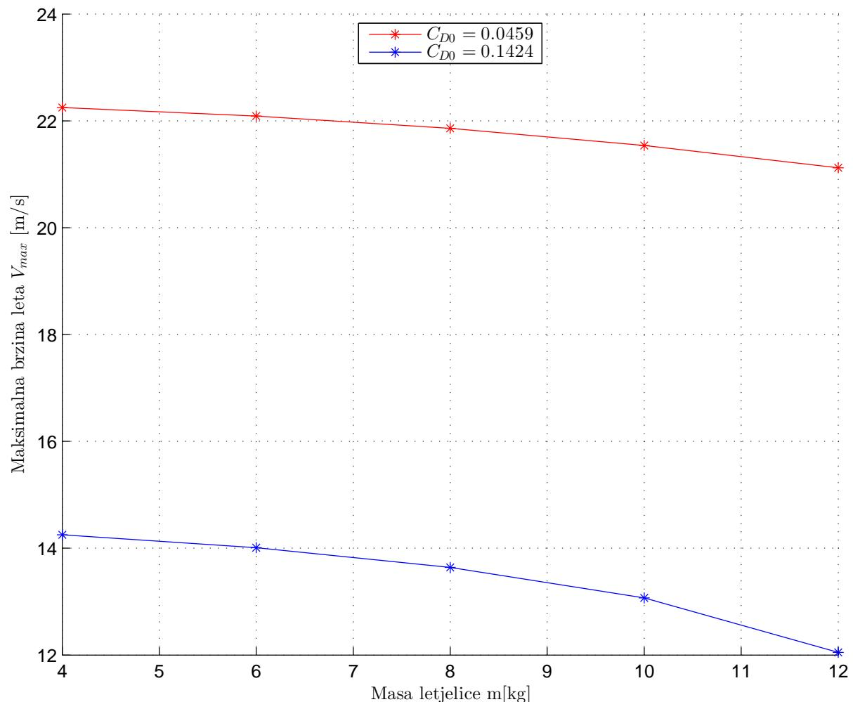
Slika 5.6: Maksimalna brzina horizontanog leta ovisno o masi letjelice  $m$  za dva različita koeficijenta nultog otpora  $C_{D0} = 0.0459$  i  $C_{D0} = 0.1424$
