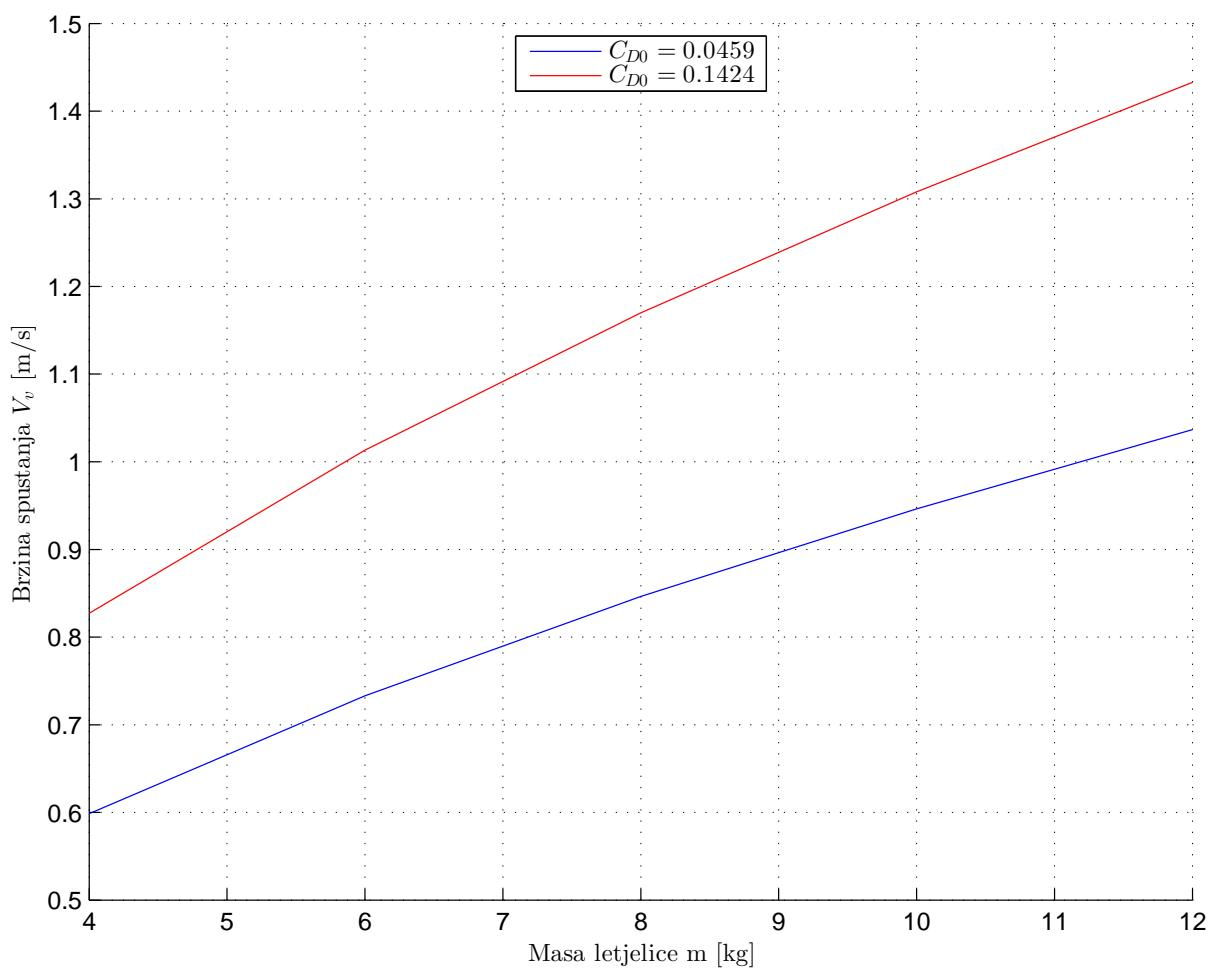
Slika 5.24: Brzina spuštanja za režim najmanje brzine spuštanja ovisno o masi letjelice  $m$  za dva različita koeficijenta nultog otpora letjelice  $C_{D0} = 0.0459$  i  $C_{D0} = 0.1424$
