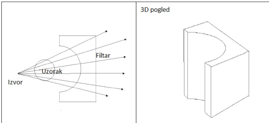
Slika 3.9: Filter za cilindrične objekte [21]
