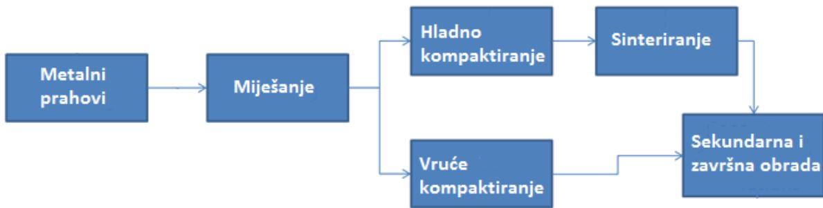
Slika 2.2: Shema proizvodnje proizvoda metalurgijom praha [6]
