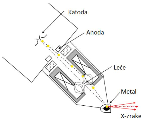
Slika 3.3: Shema proizvodnje x-zraka u CT uređaju [15]
