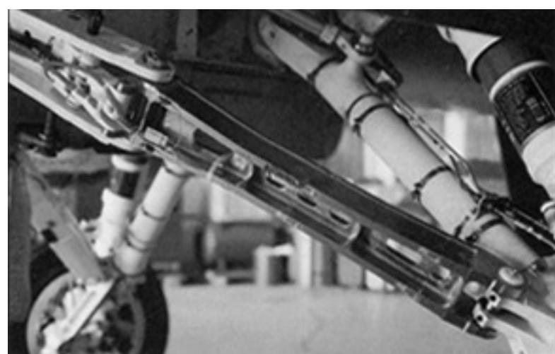
Slika 2.11: Podvozje aviona F-16 *Fighting Falcon* [14]
