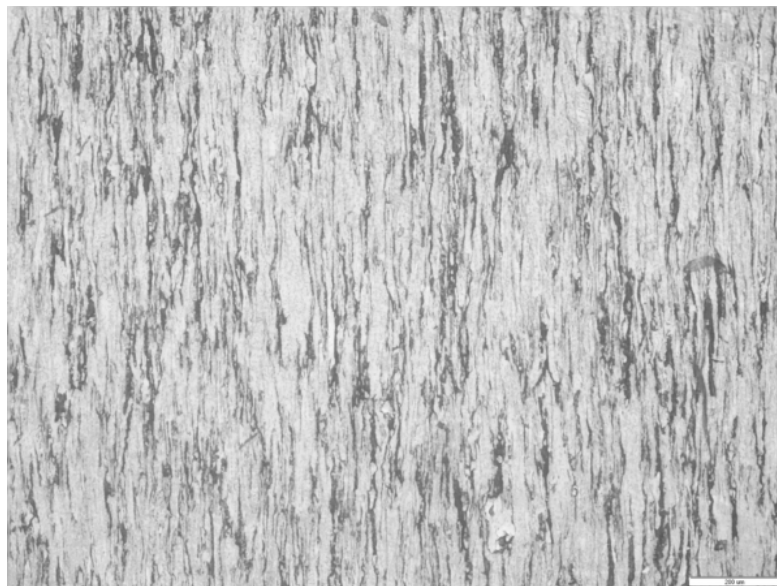
Slika 4.7: Uzdužni presjek uzorka, uvećanje 100x
