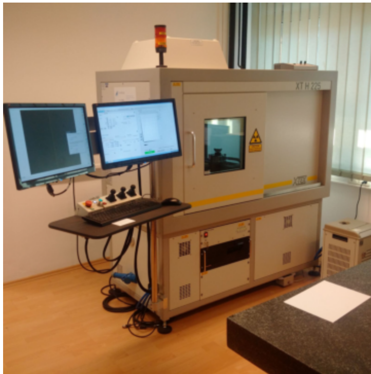
Slika 4.14: CT uređaj Nikon XT H 225
