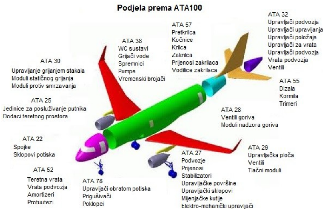
Slika 6. Podjela zrakoplova po ATA-ma [11]
