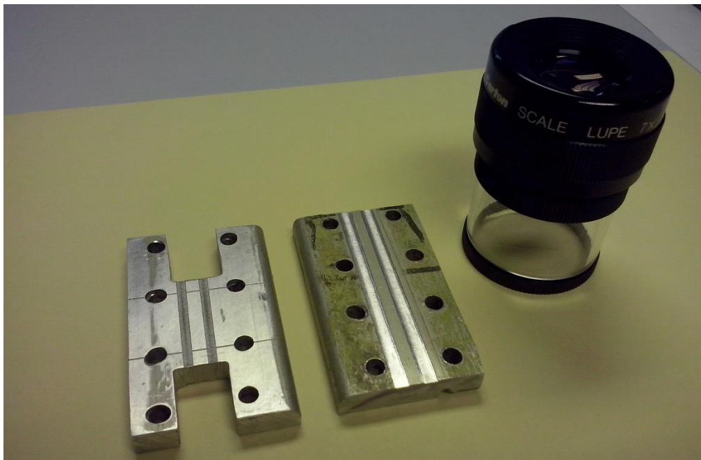
Slika 29. Očitavanje dimenzije širina oštećenja Carton scale povećalom
