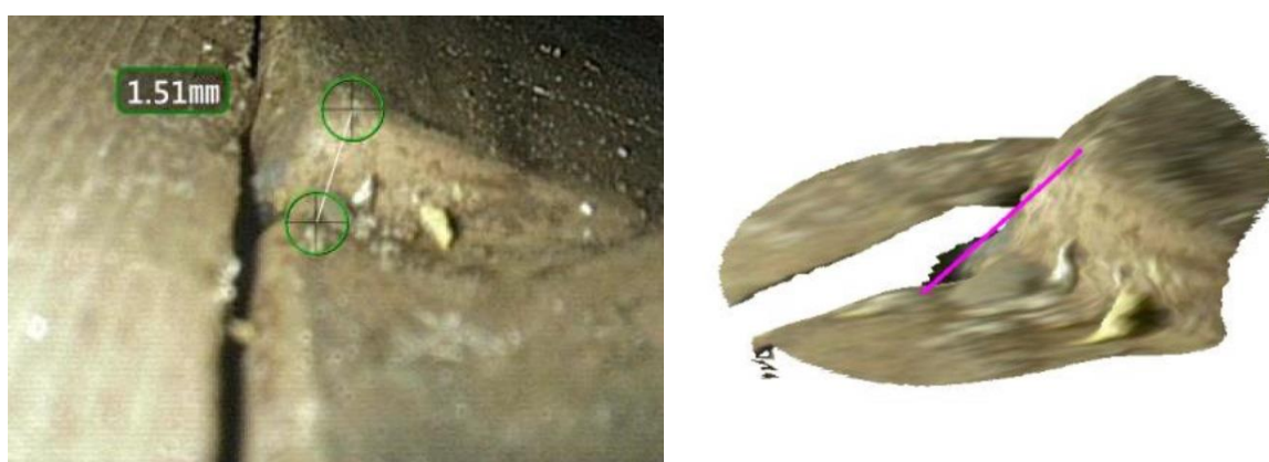
Slika 22. Očitavanje dubine oštećenja u odnosu na zadanu ravninu, dok je u 3D vidljivo da je oštećenje uleknuto [16]
