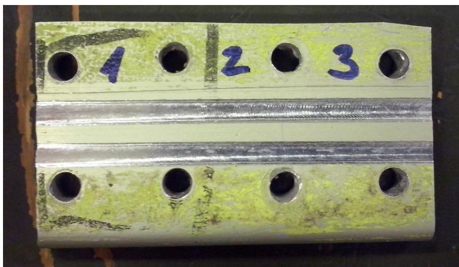
Slika 31. Uzorak 2 i oznake za mjesta očitavanja širine utora - oštećenja mikroskopom
