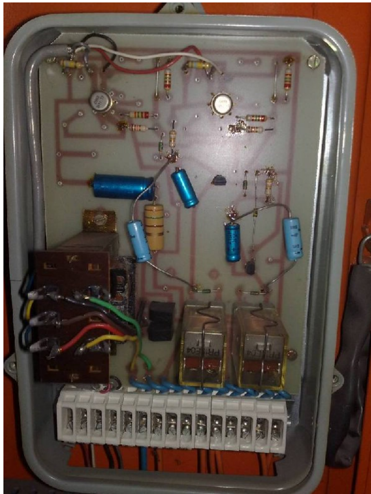
Slika 17. Sklop električnih komponenti za upravljanje radom elektromotora na osnovu signala induktivnog davača brzine vrtnje pomoćnog (srednjeg) valjka
