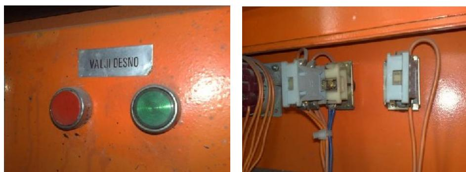
*Slika 8. Tipkalo uključivanja motora*
