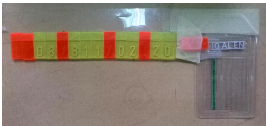
Slika 15. Indikatori kvalitete i identifikacijske oznake radiograma
