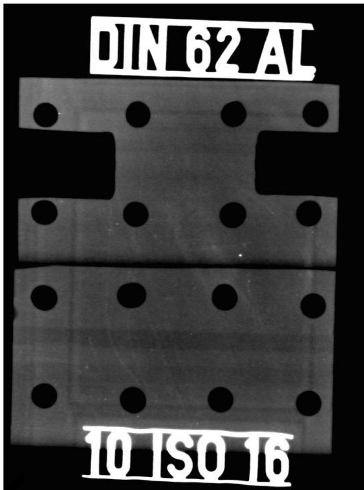
Slika 23. Radiogram dobiven GP pločom
