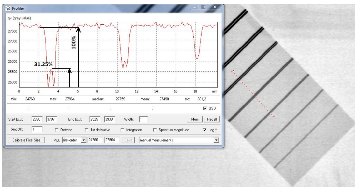
Slika 27. Prikaz određivanja prostorne razlučivosti
