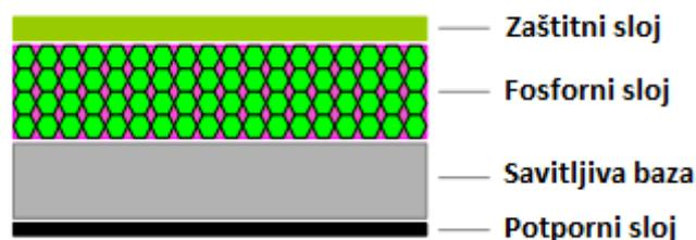
Slika 6. Presjek slikovne ploče [7]
